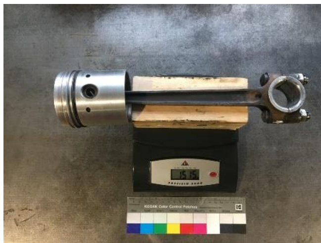
Figure 14 : Contrôle masses bielle/piston N°1
