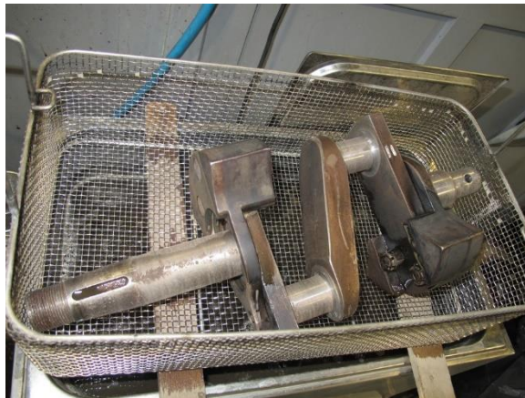
Figure 32 : Vilebrequin en préparation pour nettoyage à l'ultrason
