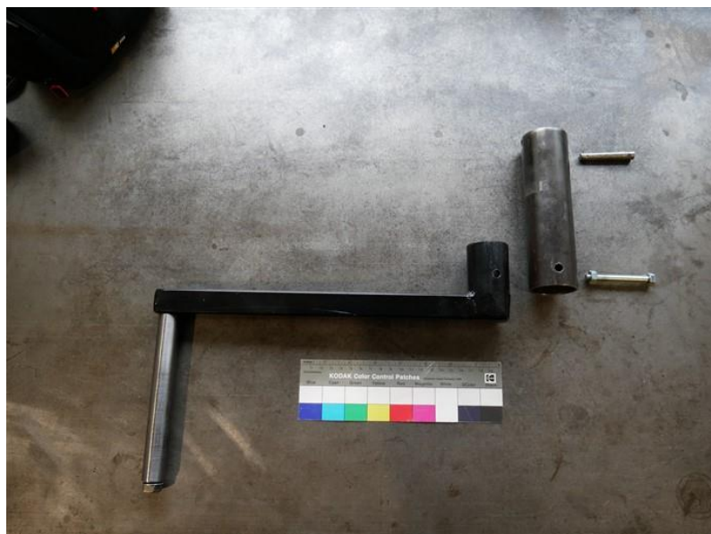
Figure 20 : Manivelle fabriquée pour entrainer manuellement le moteur
