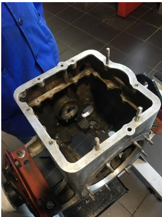
Figure 35 : Montage en cours des nouveaux goujons
