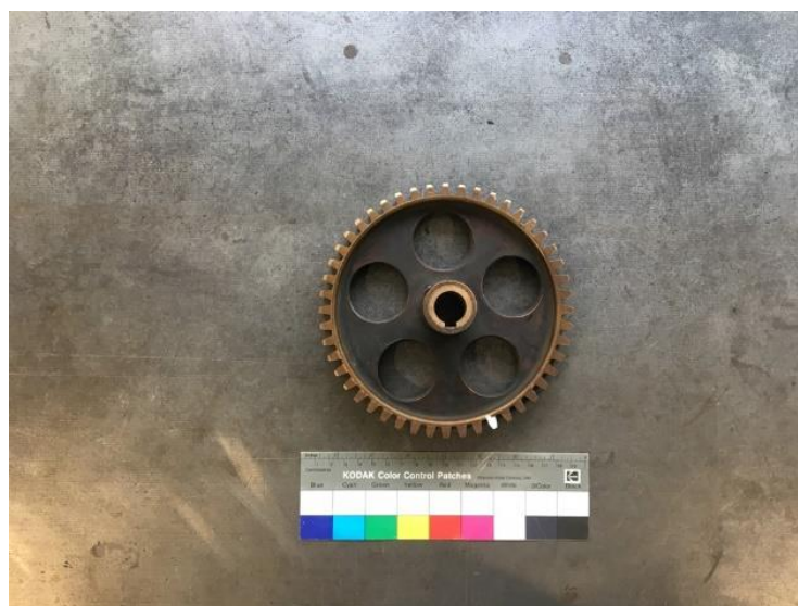
Figure 20 : Pignon de distribution monté sur l'arbre à cames
