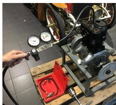
Figure 8 : Test d'étanchéité en cours sur le cylindre N°1
