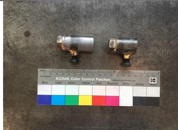
Figure 37 : Adaptateur fabriqué pour être monté à la place des manivelles des voitures
