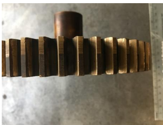
Figure 21 : Coloration à mi- dents du pignon monté sur l'arbre à cames
