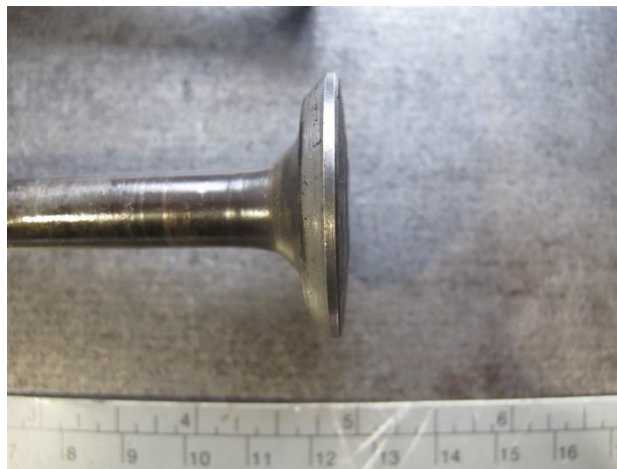
Figure 18 : Détail de la portée de la soupape d'admission N°2
