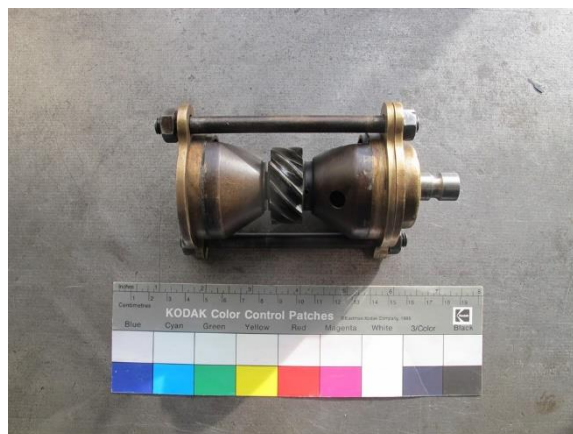
Figure 29 : Entrainement de la magnéto
