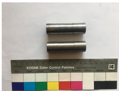
Figure 55 : En haut axe de piston du moteur, en bas axe fabriqué avec diamètre plus petit au centre, là où la bielle se positionne.
