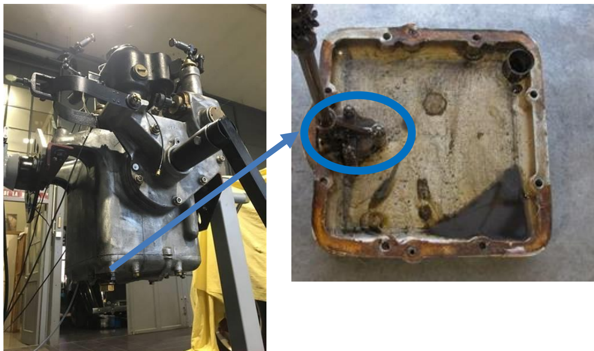
Figure 51 : Frottements dans la pompe à huile
