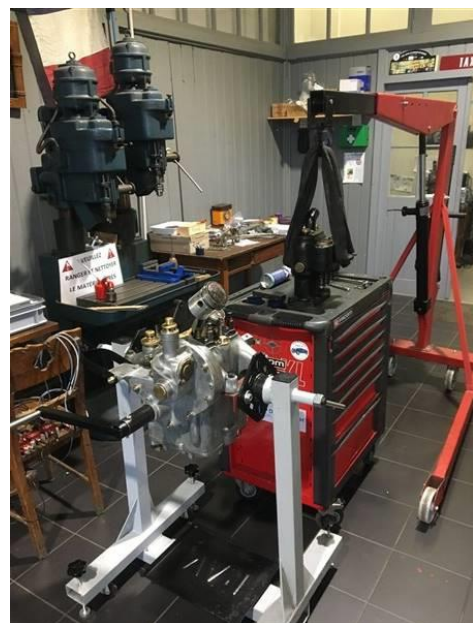
Figure 56 : Dépose du bloc moteur
