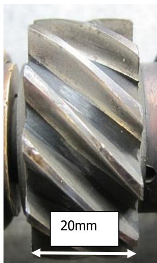
Figure 30 : Pignon d'entrainement, la finesse des dents est bien visible
