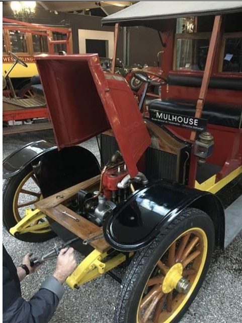
Figure 36 : Mesure du couple d'entrainement du moteur de la voiture de la collection (Inv.2209)
