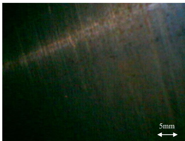
Figure 7 : Traces de déglçage et de corrosion dans le cylindre N°1
