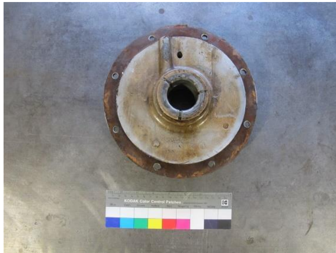
Figure 26 : Carter arrière de maintien du vilebrequin
