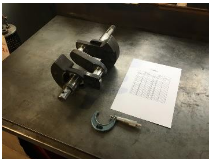
Figure 15 : Contrôle dimensionnel du vilebrequin
