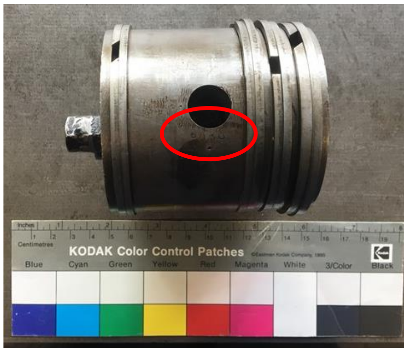
Figure 12 : Piston d'origine diamètre 80mm avec inscription 6030 juste sous le perçage l'axe
