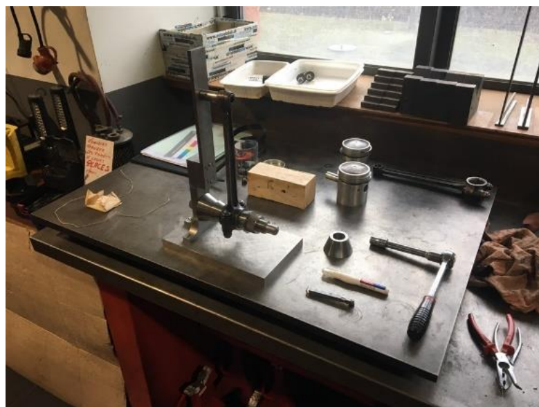
Figure 13 : Contrôle de l'équerrage des bielles
