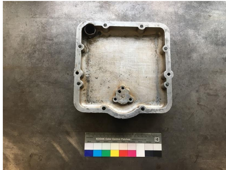
Figure 28 : Carter inférieur côté intérieur
