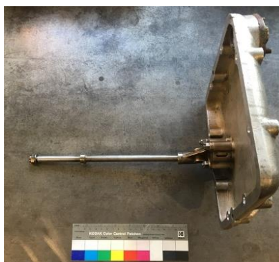
Figure 22 : Pompe à huile montée sur le carter inférieur
