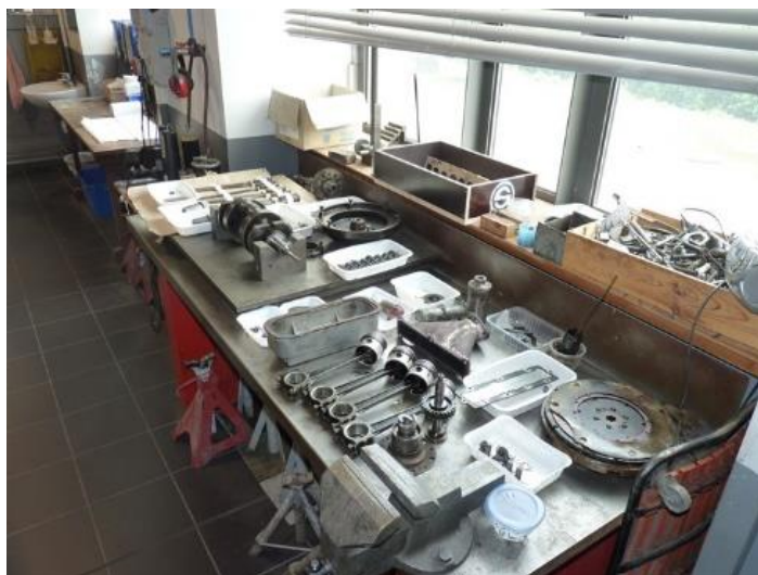
Figure 4 : Pièces du moteur de la Lambert 16 (Inv.6277.3) après démontage
