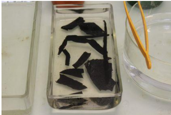
Abb. 51: Versuchsreihe 3. Diese Behandlung beginnt im \text{Na}_2\text{CO}_3 Bad. Eine Reaktion ist nicht erkennbar.
