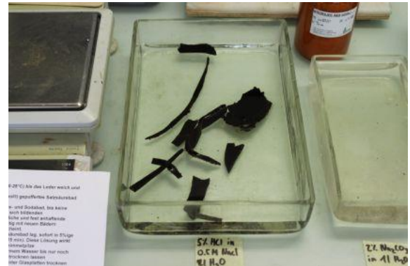
Abb. 52: Versuchsreihe 3. Nach dem Wechsel ins HCl Bad ist die Produktion von Kohlensäure relativ gering.
