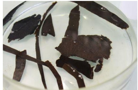
Abb. 54: Versuchsreihe 3. Nachdem die Leder zuvor ein letztes Mal im HCl Bad lagen, wurden diese in die \text{NaHSO}_3 Lösung gegeben. Es zeigte sich eine bleichende Wirkung.
