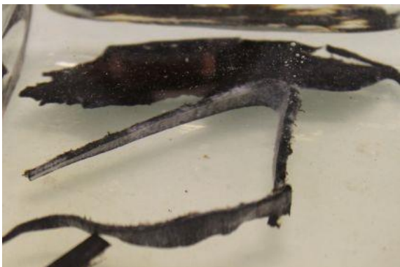
Abb. 49: Versuchsreihe 2. Der weisse Belag im \text{Na}_2\text{CO}_3 Bad ist gut erkennbar.
