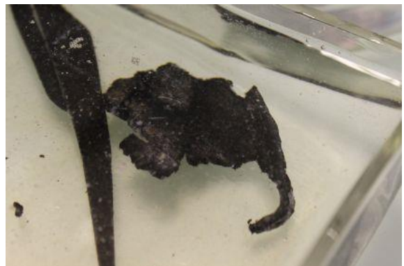
Abb. 50: Versuchsreihe 2. Der weisse Belag im \text{Na}_2\text{CO}_3 Bad ist gut erkennbar.
