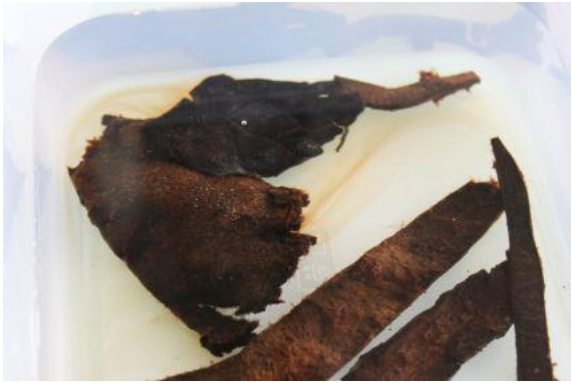
Abb. 55: Versuchsreihe 3. Bei der Spülung im Wasserbad entwich dem Leder eine bräunliche Substanz. Die Leder wirkten nach der Behandlung sichtlich faseriger und gequollen.
