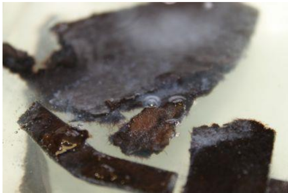
Abb. 53: Versuchsreihe 3. Beim erneuten Wechsel ins \text{Na}_2\text{CO}_3 Bad findet eine sehr starke und intensive Blasenbildung statt. Zudem tritt erneut eine weissliche Substanz aus dem Leder aus. Das Leder wirkte aufgequollen und faserig.
