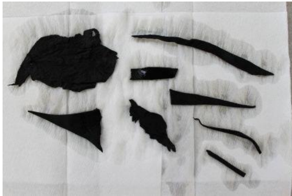
Abb. 61: Nach der Wasserspülung wurden die Leder auf eine Glasplatte zwischen Papiertücher gelegt. Nach dem die Leder leicht angetrocknet (gewelkt) waren, wurden sie entsprechend ihrer Versuchsreihe behandelt und abgepresst.
