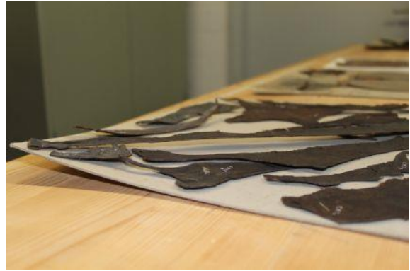
Abb. 42: Verformung der Kartontafel durch Schrumpfungerscheinungen im Leder.
