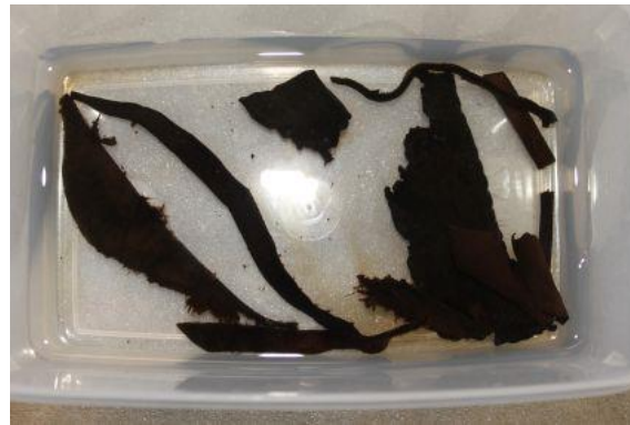
Abb. 60: Versuchsreihe 4. Das Wasser verfärbte sich in der Spülphase wiederholt, wobei klar erkennbar war, dass nur einzelne Objekte eine braune Substanz absonderten. Nach ca. 24 h zeigte das Spülwasser immer noch eine leichte Verfärbung.
