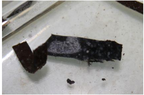
Abb. 48: Versuchsreihe 2. Im \text{Na}_2\text{CO}_3 bildet sich auf der Oberfläche ein weisser Belag. Dieser tritt auch aus dem Corium zusammen mit Kohlensäure aus. Zudem lösen sich zahlreiche kleine Fragmente von den Lederobjekten. Der weisse Belag wurde beprobt.
