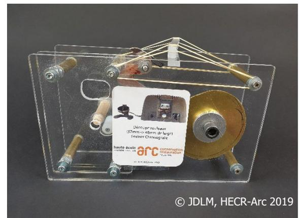
Figure 143 : Dispositif de découpe de rouleaux
