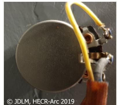
Figure 15 : Le potentiomètre présent dans notre système électrique
