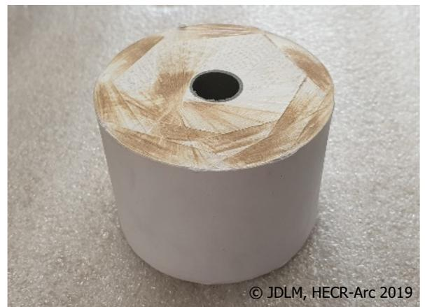
Figure 139 : Scie à ruban - vue générale du rouleau obtenu
