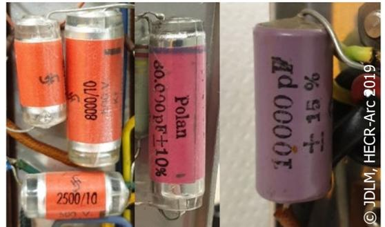
Figure 16 : Exemples des condensateurs au mica présents dans notre objet
