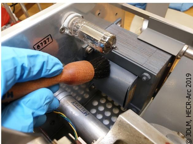
Figure 64 : Dépoussiérage à la brosse du système électrique
