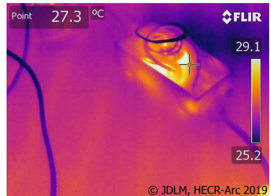
Figure 80 : Cliché thermique de notre transformateur après 1 heure de fonctionnement
