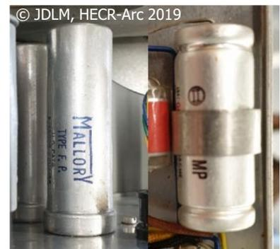
Figure 20 : Exemples de condensateurs polarisés présents sur notre appareil
