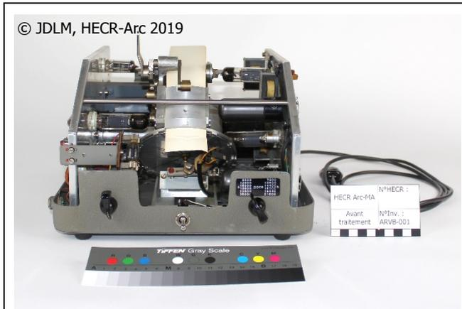
Figure 156 : Vue de face de l'appareil Greiner Chronografic sans capot (Avant traitement)
