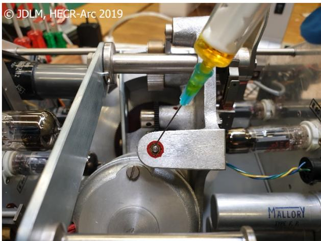
Figure 207 : Lubrification du palier
