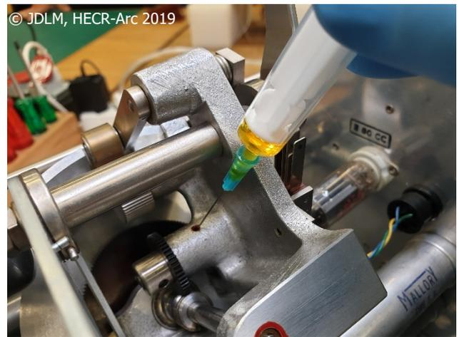
Figure 208 : Lubrification de la seconde cavité
