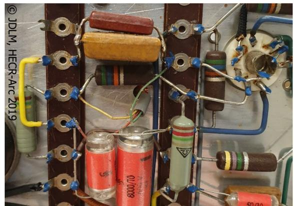
Figure 63 : Exemple des soudures réalisées et marquées manuellement
