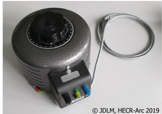
Figure 78 : Variateur de tension alternative
