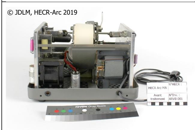
Figure 158 : Vue de dos de l'appareil Greiner Chronografic sans capot (Avant traitement)
