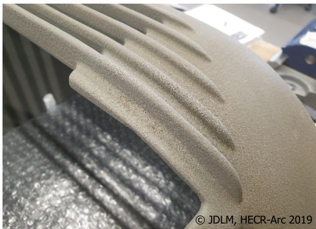
Figure 166 : Empoussièrement/Encrassement - Vue de détail N°3
