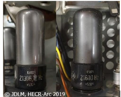
Figure 26 : Exemples de quartz présents dans notre système électrique
