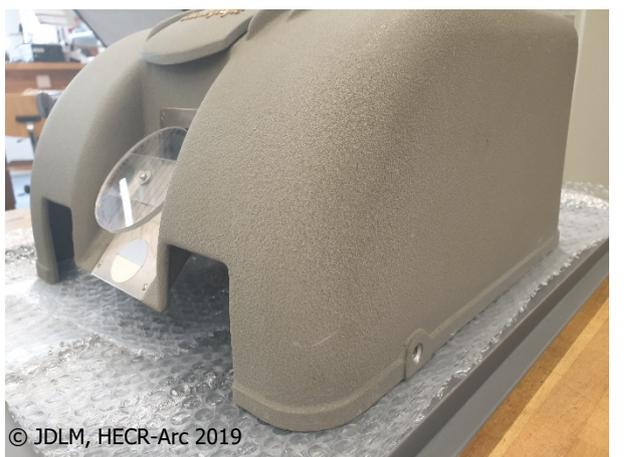
Figure 170 : Abrasion et rayures de surface
