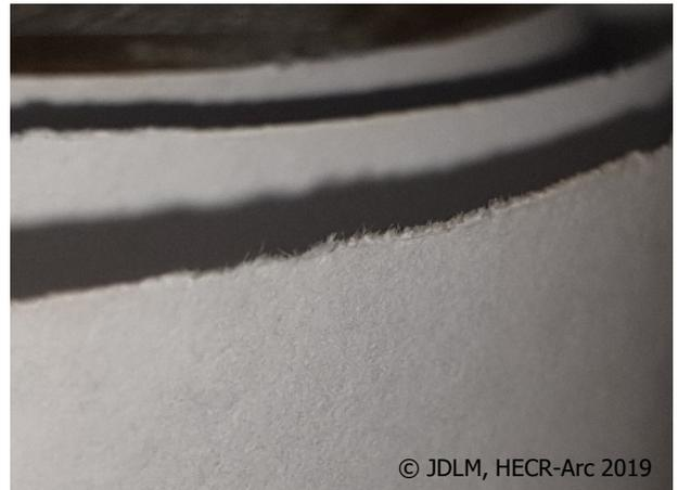
Figure 140 : Scie à ruban - Vue des fibres en bordure de papier
