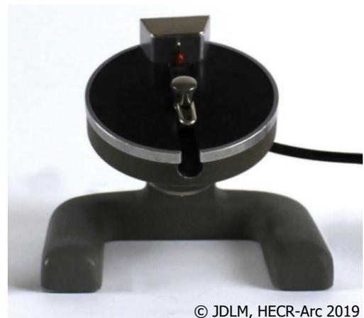
Figure 27 : Le micro piézo-électrique de notre appareil Greiner Chronografic
