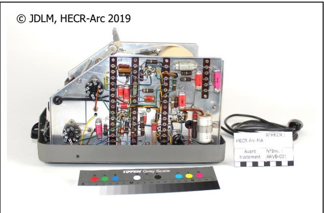
Figure 157 : Vue de profil droit de l'appareil Greiner Chronografic sans capot (Avant traitement)
