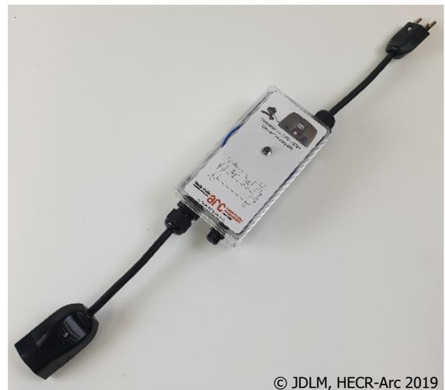
Figure 79 : Boîtier convertisseur de tension
