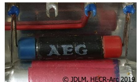
Figure 22 : Exemple d'une diode présente dans notre système électrique
