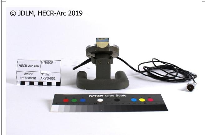
Figure 163 : Vue de dos du microphone de l'appareil Greiner Chronografic (Avant traitement)
