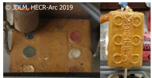
Figure 17 : Condensateurs "Palquettes" présents sur notre chrono-compareur
