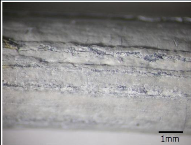
Photo 47 : Aspect de la surface de l'échantillon après trente minutes de réduction avec le Pleco
