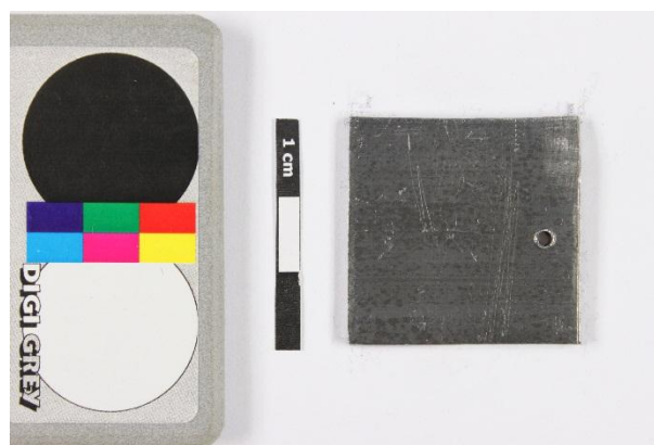
Photo 22 : Exemple d'un échantillon de type 1 en plomb
