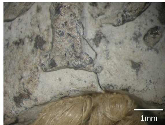
Photo 79 : Fente au niveau du lacs sortant
