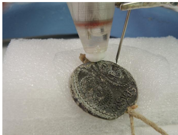
Photo 82 : Vue du Pleco en contact avec les produits de corrosion lors du traitement
