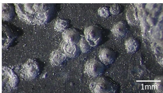
Photo 92 : Produits de corrosion sous forme de bubons
