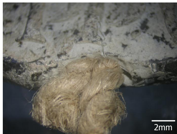
Photo 77 : Produit de corrosion au niveau de l'interface avec le lacs sortant
