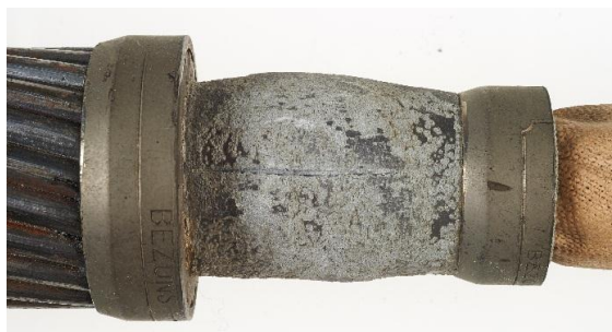
Photo 91 : Produits de corrosion recouvrant de larges surfaces
