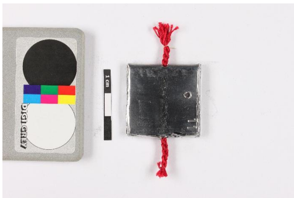
Photo 23 : Exemple d'un échantillon de type 2 en PbSn5
