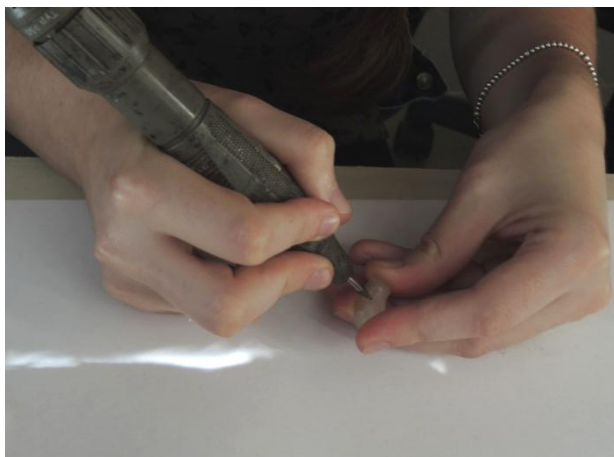
Photo 15 : Finition du bouton poussoir au microtour
