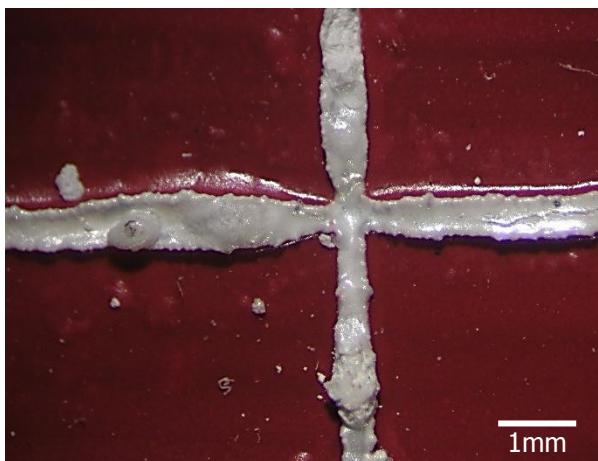
Photo 3 : Produits de corrosion formés sur le PbSn50 avant traitement
