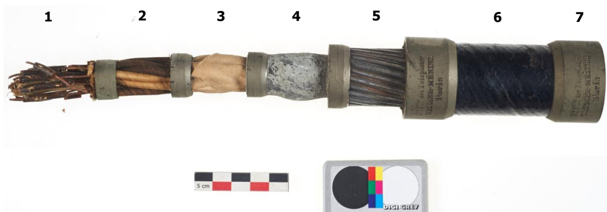
Photo 1 : Vue du câble Rattier-Menier avant traitement (les différentes parties sont numérotées)
