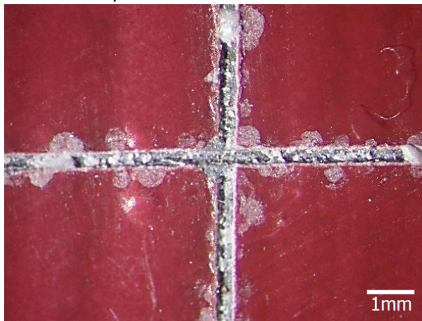
Photo 1 : Produits de corrosion formés sur le plomb avant traitement
