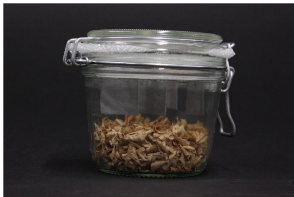
Photo 1 : Exemple d'échantillon de plomb type 1 corrodés en présence de chêne
