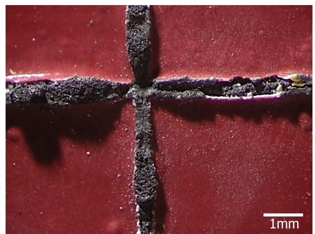
Photo 4 : Produits de corrosion formés sur le PbSn50 après traitement
