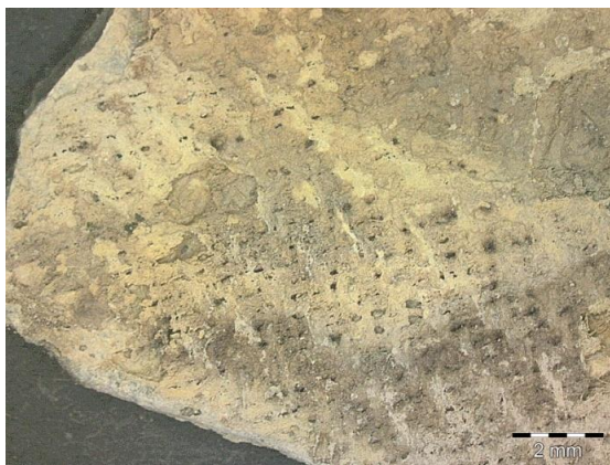
Figure 27 : Croûte de sédiment semblable à une trame de tissu, 1004-22 verso fragment B, loupe binoculaire, 0.67x ©HECR-Arc, 2013.
