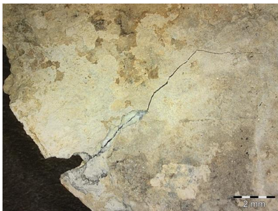
Figure 30 : Fissure transversale située au niveau du bord, 1008-1 recto fragment A, loupe binoculaire, 0.67x ©HECR-Arc, 2013.
