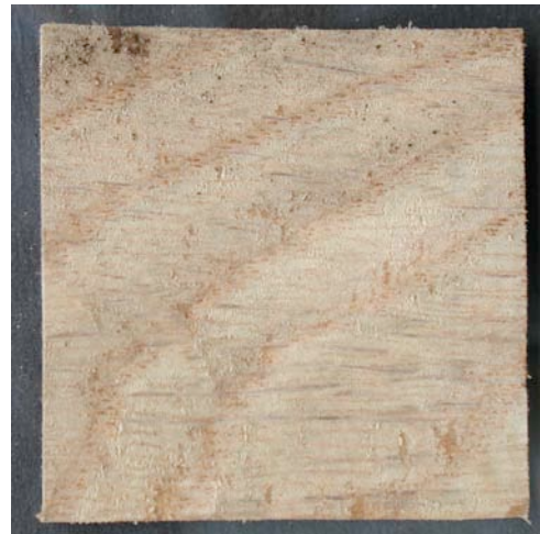
Abb. 55 und 56. Nach achtwöchiger Vorinkubationszeit in der Feuchtkammer bei 23° C und ca. rLF 95% der Fichten- und Eichenholzproben vor dem Versuch der Reinigung und Auftragen der Prüfsubstanzen
