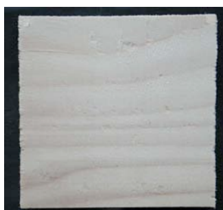
Abb. 71. Verschimmelte Fichtenholzprobe von Satureja montana . Myzelwachstum und Sporulierung sind nur unter der Lupe sichtbar.
