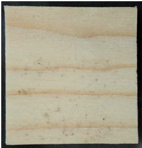
Abb. 55 und 56. Nach achtwöchiger Vorinkubationszeit in der Feuchtkammer bei 23° C und ca. rLF 95% der Fichten- und Eichenholzproben vor dem Versuch der Reinigung und Auftragen der Prüfsubstanzen
