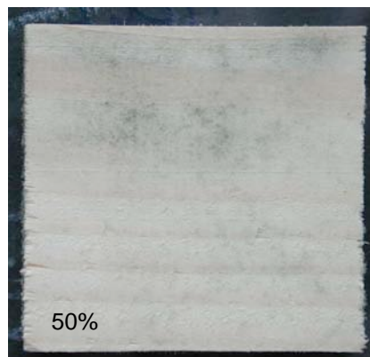
Abb. 47 bis 50. Die mit Eugenia caryophyllata behandelten Fichtenholzproben mit den Konzentrationen 50% bis 1% nach der Standardalterung und 13-wöchiger Inkubationszeit
