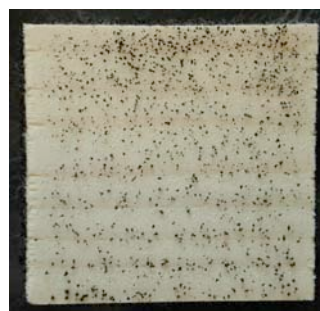
Abb. 72. Sporulierung von Aspergillus niger sowie Myzelwachstum sind auf der Fichtenholzprobe von Cinnamomum zeylanicum gut erkennbar.
