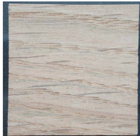
Abb. 57 und 58. Die gereinigte und mit Cinnamomum zeylanicum 50% behandelte Fichtenholzprobe nach sechzehnwöchiger Inkubationszeit links, und rechts die mit Origanum vulgare 1% behandelte Eichenholzprobe nach gleich langer Inkubationszeit
