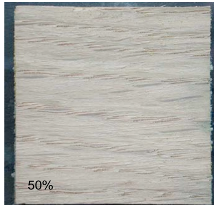
Abb. 51 bis 54: Die mit Eugenia caryophyllata behandelten Eichenholzproben mit den Konzentrationen 50% bis 1% nach der Standardalterung und dreizehnwöchiger Inkubationszeit
