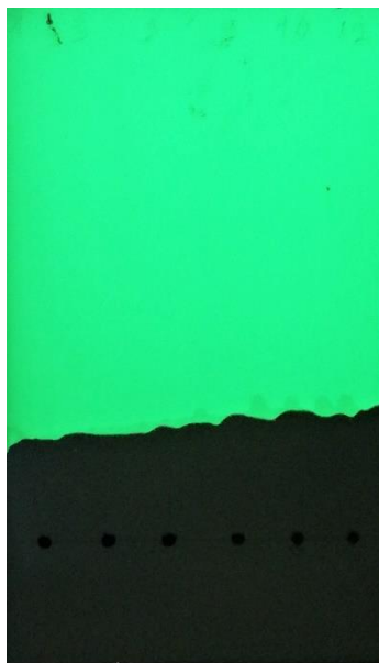
Figure 41: idem que figure 40, vu aux UV (254 nm) qui révèlent la destruction de l'indicateur.
