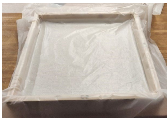
Fig. 93 : Évaluation des systèmes moussants - mortier recouvert d'une bâche fine
