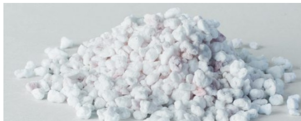
Fig. 52 : Perlite — roche volcanique expansée
