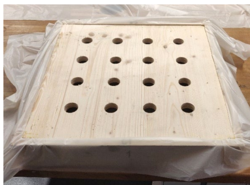
Fig. 94 : Évaluation des systèmes moussants - coffrage fermé avec couvercle ajouré
