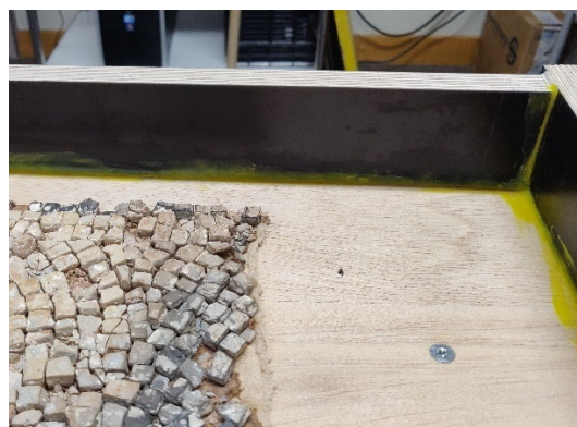
Fig. 84 : En cours de traitement - Colmatage des jointures avec de la Plastiline®
