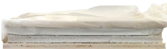
Fig. 97 : Résine époxy moussante – vu de profil
