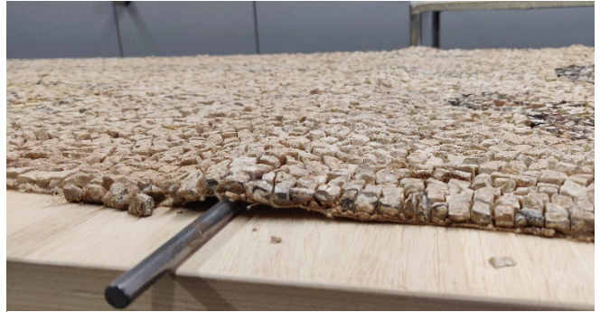
Fig. 72 : En cours de traitement - Dépoussiérage des joints dont l'accès est facilité par l'utilisation d'une tige en métal placée sous le Tessellatum
