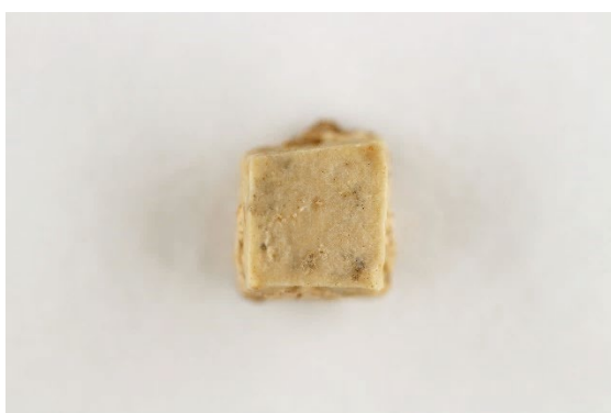
Fig. 40 : Tesselle beige dissociée - face arrière avec des arêtes vives
