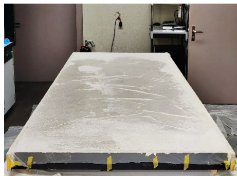
Fig. 100 : En cours de traitement - après l'application de la couche d'époxy liquide
