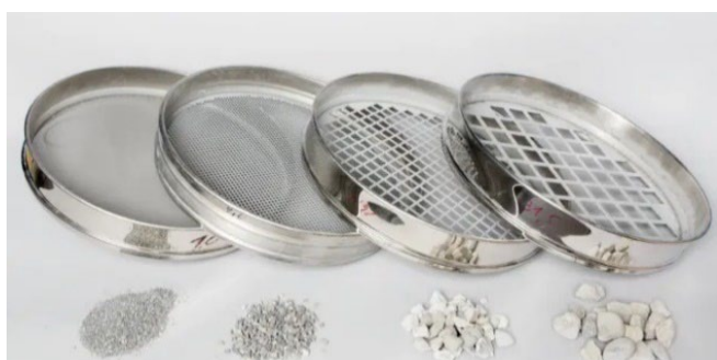
Fig. 150 : Exemple de tamis normalisés
