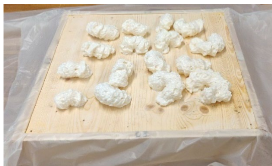
Fig. 96 : Essai de semelle avec de la mousse polyuréthane expansive - en cours d'expansion - vu du dessus
