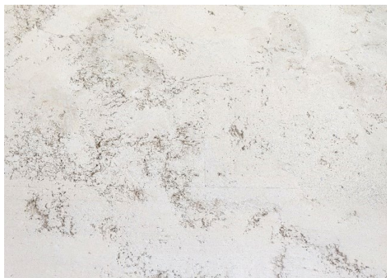
Fig. 90 Surface de la couche d'intervention à base de chaux avant comblement des aspérités
