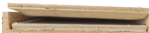
Fig. 98 : Mousse polyuréthane expansive – vu de profil - phénomène de décompression menant à la déformation de la semelle (la bâche a été retirée pour faciliter la compréhension du phénomène)
