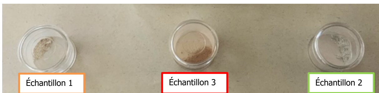
Fig. 132 : Échantillon sous forme de poudre analysé par diffraction des rayons X
