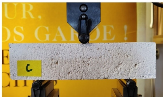
Test de flexion en 3 point - Mortier C
