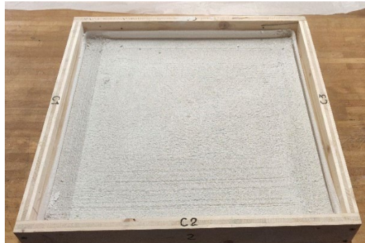
Fig. 92 : Coffrage en bois réalisé pour évaluer les systèmes moussants
