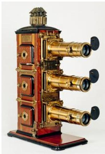
Figure 4 : Triple lanterne de projection « The Noakes' Triple » contenant de l'amiante<sup>97</sup> ©Cinémathèque française
