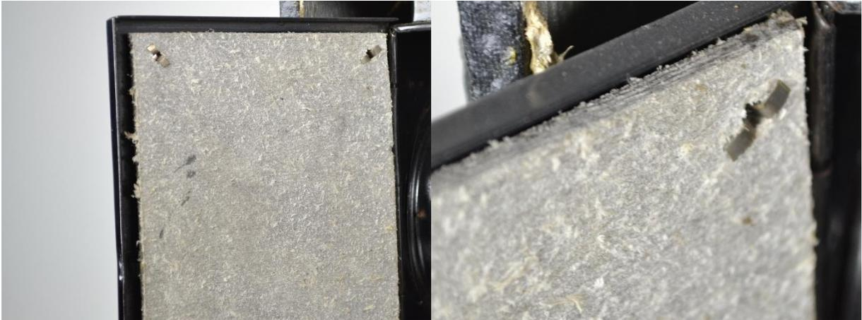
Figure 15 : Aspect fibreux d'une plaque d'amiante
