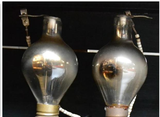
Figure 28 : Irisation des ampoules à mercure
