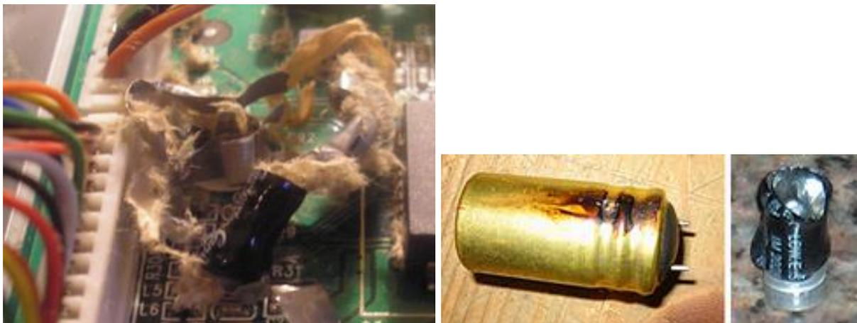
Figure 49 : Explosion et gonflement d'un condensateur au papier métallisé ©Tsf Resto
