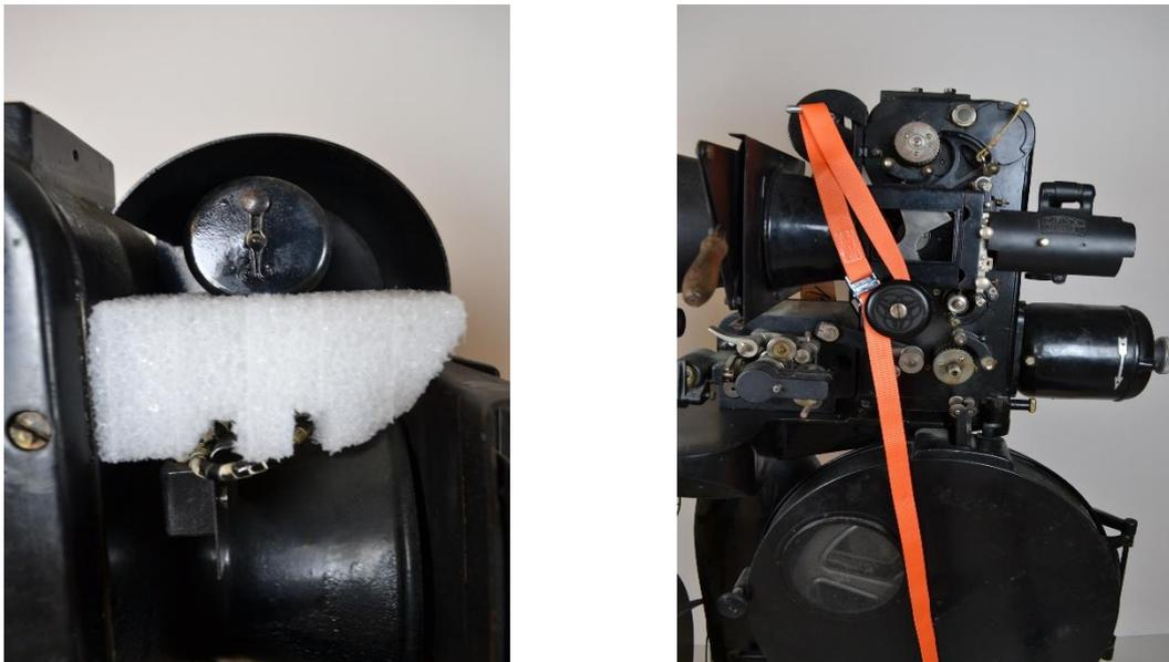
Figure 52 : Calage d'un interrupteur à mercure par placement d'une mousse en polyéthylène au niveau des contenants à mercure et par sanglage du système coupe-feu à bascule afin de limiter tout mouvement
