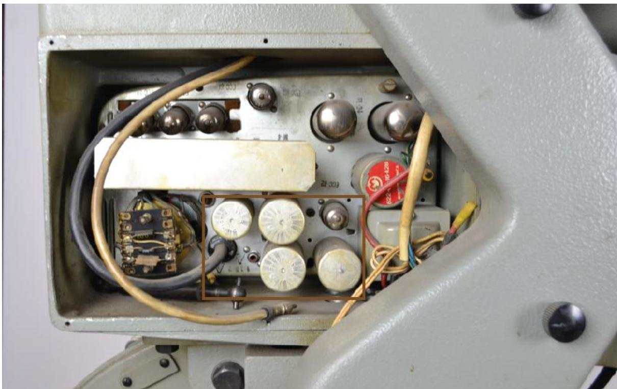
Condensateurs à tube suspectés de contenir des PCB
