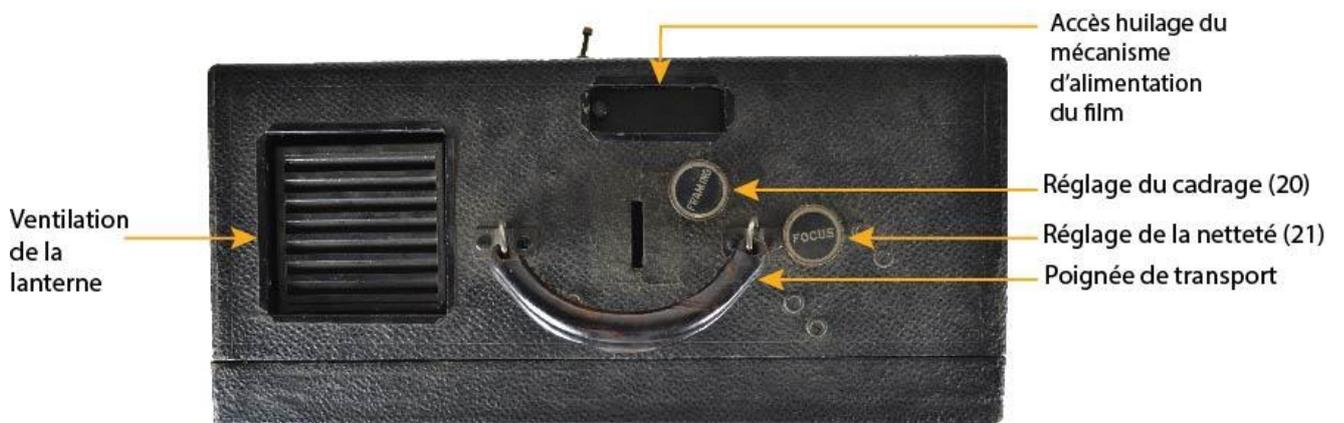
Figure 68 : Haut de l'appareil Acme
