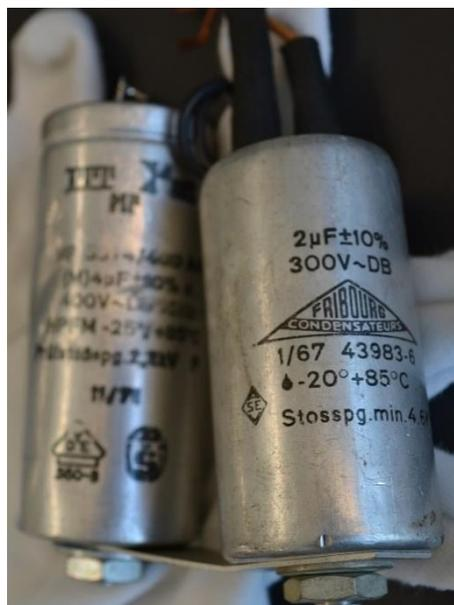
Figure 90 : Condensateur dextre du projecteur Bauer M7 suspecté de contenir des PCB
