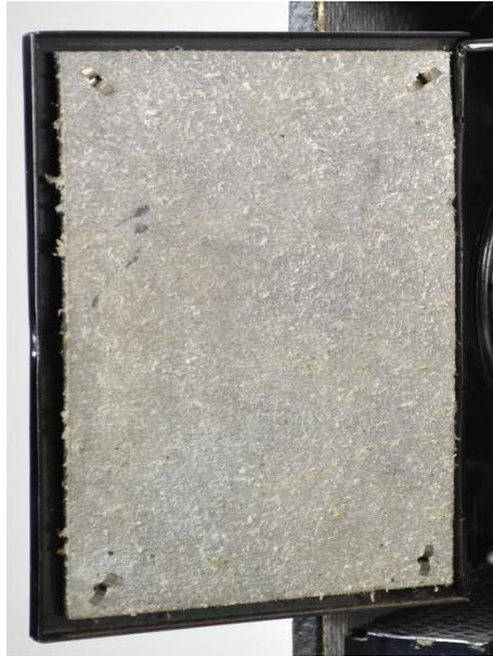
Figure 73 : Amiante en plaque faiblement agglomérée du projecteur Acme
