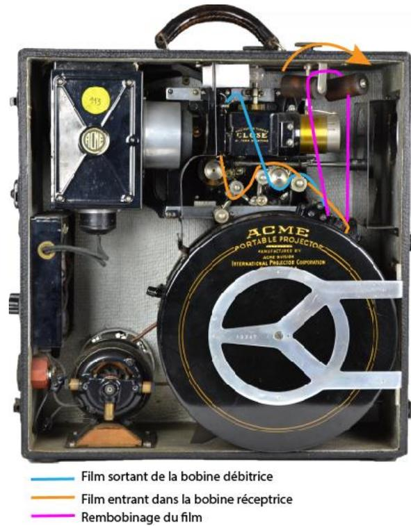
Figure 71 : Placement et rembobinage du film, Acme
