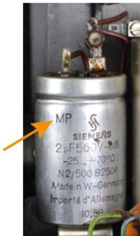
Figure 40 : Exemple de condensateur à tubes en papier métallisé « MP »
