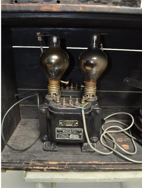
Figure 25 : Redresseur à mercure interne à l'appareil, Cinématographe Pathé, 1920
