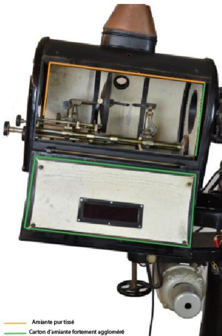
Figure 88 : Amiante dans la lanterne, Bauer M7
