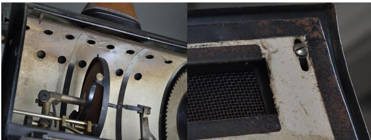
Figure 45 : Brunissement et soulèvements et dépôts de suie, lanterne Bauer M7
