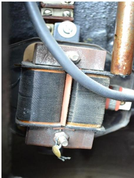
Figure 33 : Transformateur sec dans l'appareil Ernemann IV, fournissant une tension plus basse pour le lecteur sonore
