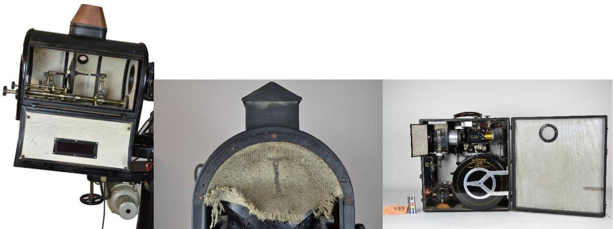
Figure 8 : Amiante dans une lampe à arc, Bauer M7, 1928
