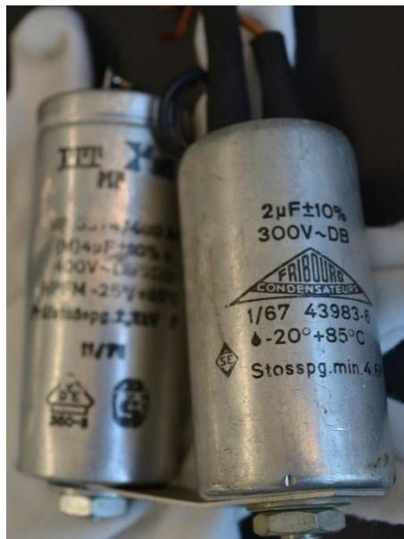
Figure 43 : Condensateur dextre suspecté de contenir des PCB
