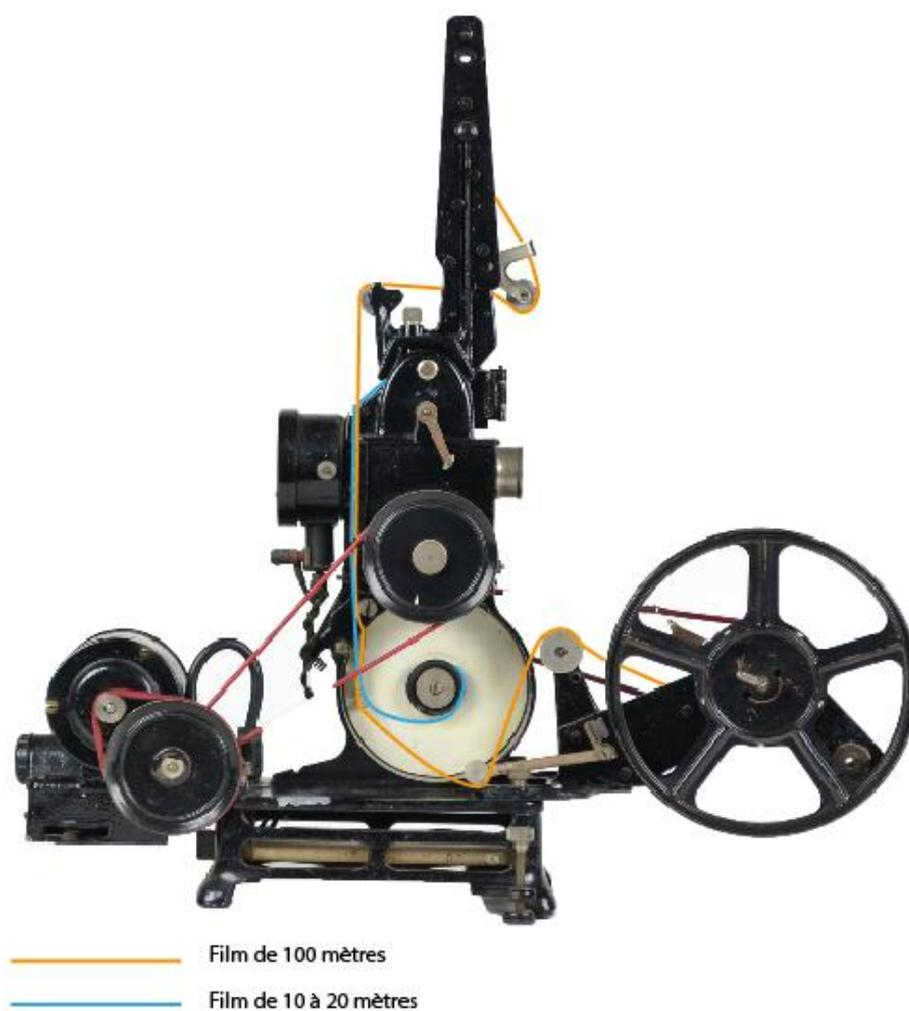
Figure 81 : Mise en place du film sur le Pathé Baby Super
