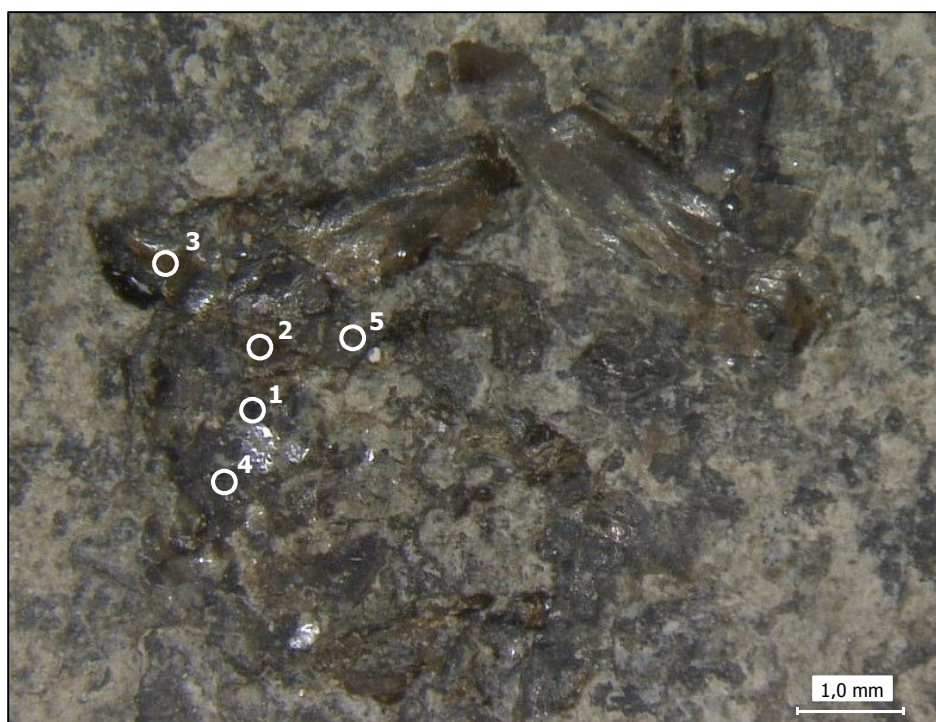
Fig. A4.1 : « Spécimen 1 », grossissement 7.5X. Le spécimen se distingue de la matrice par sa couleur plus foncée et par sa brillance. Les cercles blancs indiquent l'emplacement des analyses Raman (Fig. A3.2). C.Bugnon©CRCC
