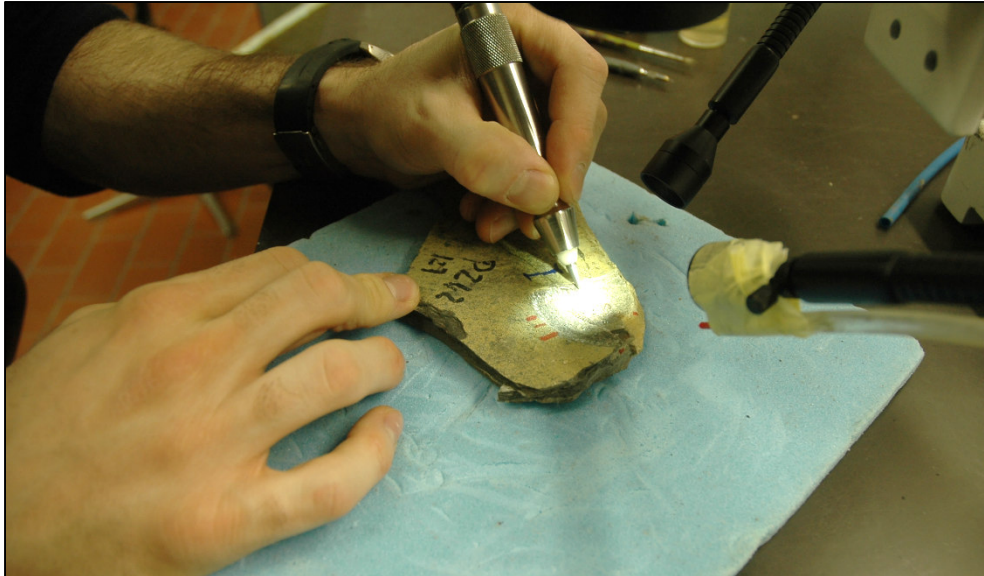
Fig. 9 : Dégagement mécanique au microburin pneumatique, sous loupe binoculaire. Le tuyau fixé à la fibre optique, à droite de l'image, est l'arrivée d'air soufflant les poussières produites lors du dégagement. C.Bugnon©MCSN
