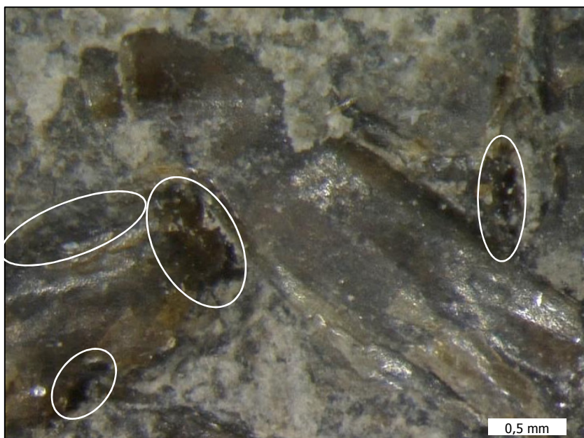
Fig. A4.3 : Zone du « Spécimen 1 » photographiée et cartographiée au MEB-SDE (Fig. A3.4 et A3.5). Grossissement 20X. Les ovals blancs indiquent l'emplacement de zones plus noires. C.Bugnon©CRCC
