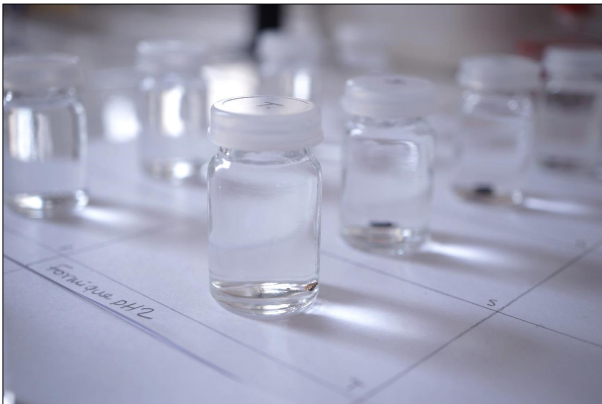
Fig. 24 : Test d'immersion d'écailles fossiles en solutions acides. C.Bugnon©CRCC
