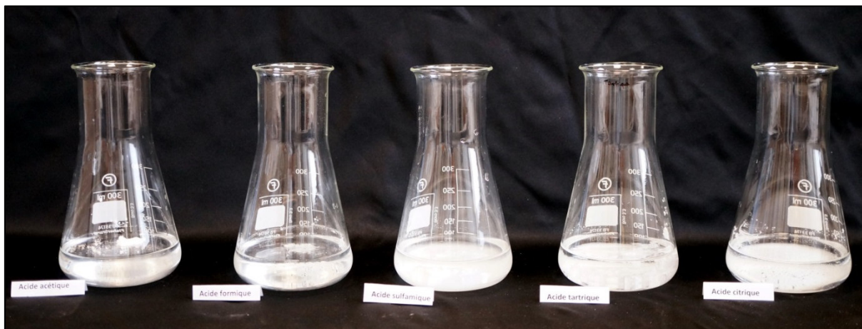
Fig. 27 : Expérience d'immersion de 1 g de calcite en poudre en solutions acides à pH 2. De gauche à droite : acide acétique, formique, sulfamique, tartrique et citrique. Photographie après 15 minutes. C.Bugnon©CRCC
