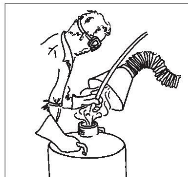
Fig. 4: aspiration des vapeurs corrosives.
