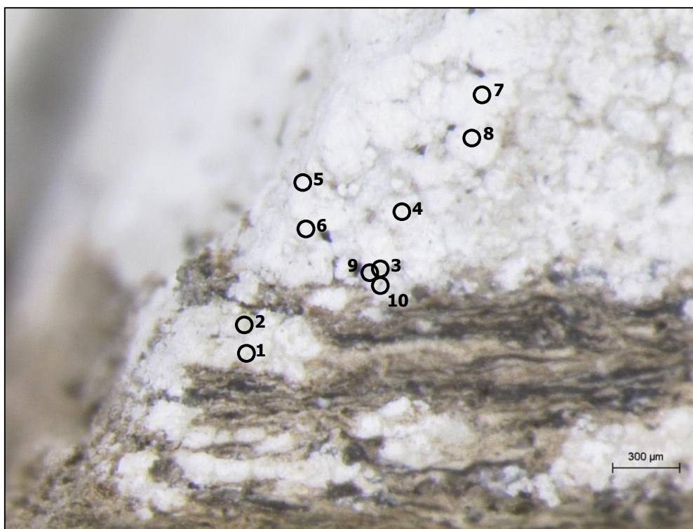
Fig. A27.24 : Détail de l'échantillon correspondant à la zone cartographiée au MEB-SDE (Fig. A27.27). Les cercles noirs indiquent l'emplacement des analyses Raman (Fig. A27.25). Grossissement 32X. C.Bugnon©CRCC
