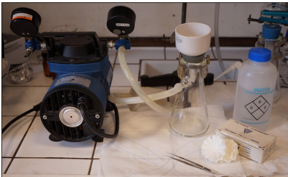
Fig. 38 : Après 24 heures d'immersion, les écailles ont été récupérées par filtration des solutions. C.Bugnon©CRCC
