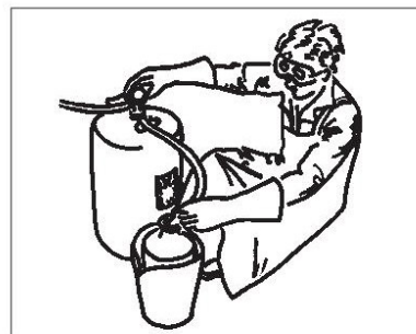
Fig. 6: transvasement avec une pompe manuelle.
