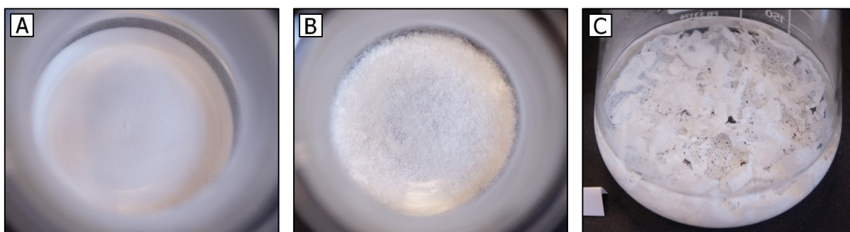
Fig 28 : Après 20 heures d'immersion de poudre de calcite : résidus présents au fond des solutions d'acide sulfamique (A), tartrique (B) et citrique (C) à pH 2. C.Bugnon©CRCC
