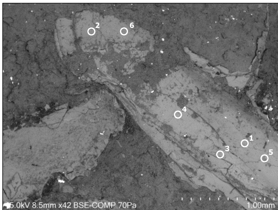
Fig. A4.4 : Image MEB de l'emplacement indiqué par un rectangle blanc sur la Fig. A3.3, correspondant à la zone cartographiée (Fig. A3.5). Les cercles blancs indiquent l'emplacement des pointés MEB-SDE, détaillés dans le Tableau A3.1. C.Bugnon©CRCC
