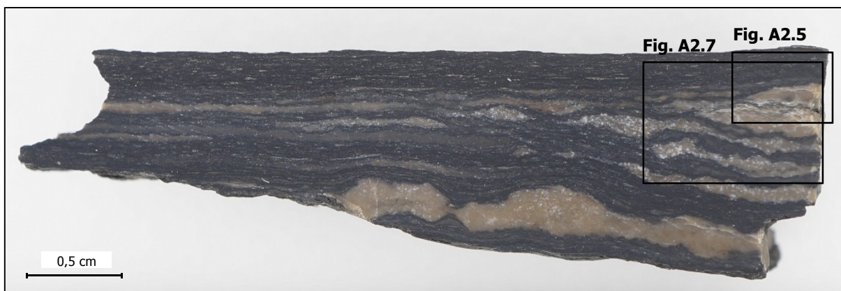
Fig. A3.4 : Echantillon de matrice employé pour les analyses Raman et MEB. Les rectangles noirs indiquent les emplacements des Fig. A2.5 et A2.7. C.Bugnon©CRCC
