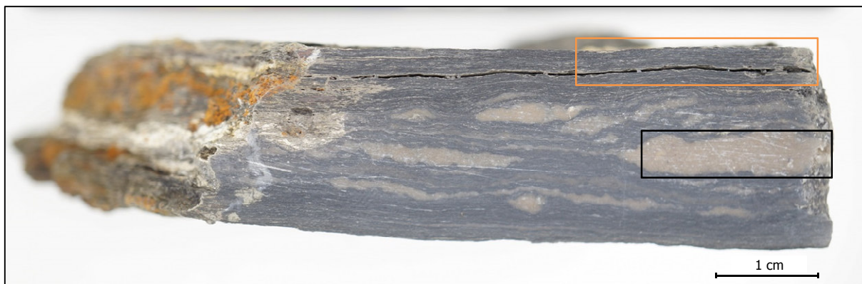
Fig. A3.1 : Échantillon analysé par DRX. Le rectangle orange indique l'emplacement de prise d'échantillon pour l'analyse des zones gris-noir de la roche. Le rectangle noir indique celui pour l'analyse des nodules calcaires. C.Bugnon©CRCC
