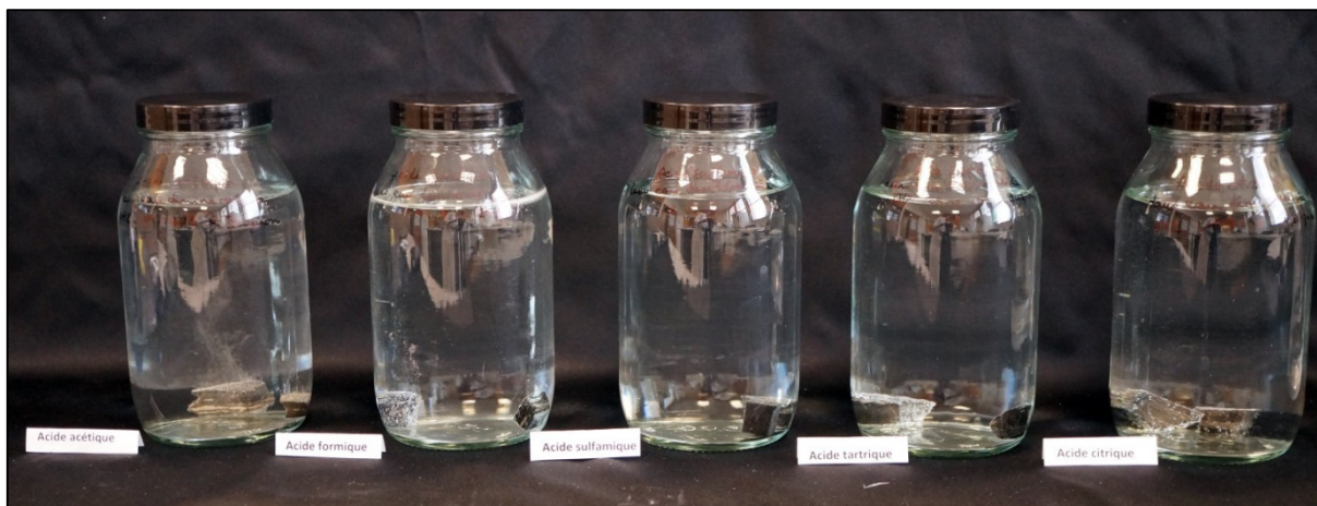
Fig. 30 : Immersion d'échantillons de matrice en solutions acides à pH 2. De gauche à droite : acide acétique, formique, sulfamique, tartrique et citrique. Photographie aussitôt après immersion. C.Bugnon©CRCC
