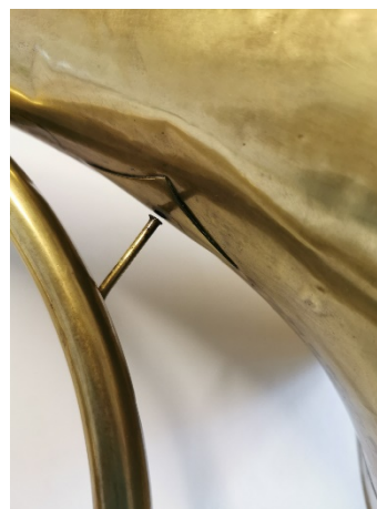
fig. 29 Fracture sur le cor d'intervention Korn (n°9).
