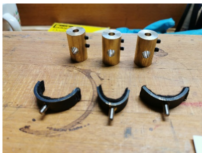
fig. 49 Fabrication des douilles et pinces pour le soclage.
