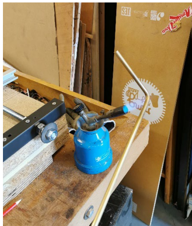
fig. 40 Recuit au chalumeau pour permettre de plier les tiges de laiton aux angles et formes voulues.
