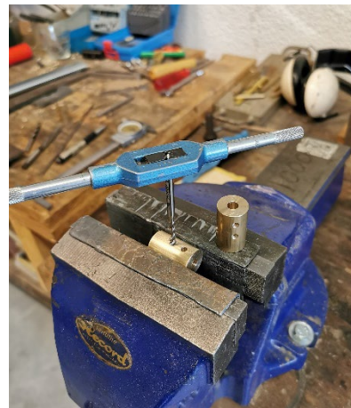
fig. 41 Taraudage M4 des douilles usinées au tour conventionnel.
