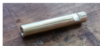
fig. 38 Un plat est limé sur la tige afin d'assurer un serrage optimal.
