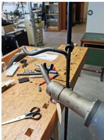
fig. 57 Rétraction de la gaine avec un propulseur d'air chaud.
