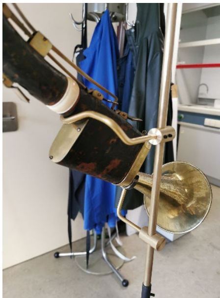
fig. 42 Support en tige pliée et en pince pour soutenir la partie basse du cor de basset (n°1).
