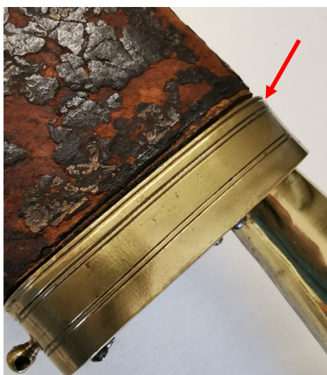
fig. 26 Cor de basset n°1 : Ouverture due à la séparation de parties.
