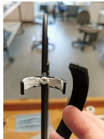
fig. 56 Collage des feutres sur les pinces.
