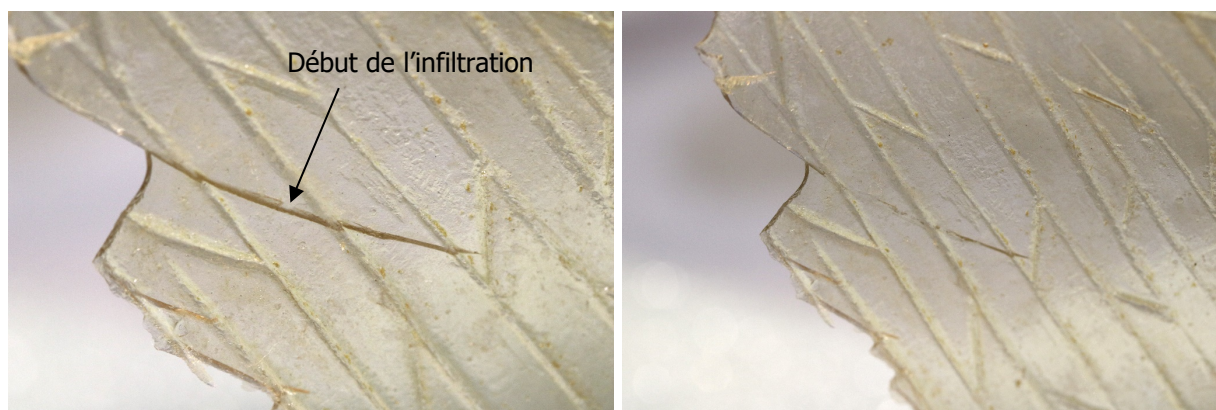
Fig. 167 Infiltration d'une cassure fermée
