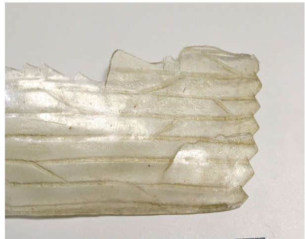
Fig. 161 Fragment après retrait des résidus de masse adhésive au KSG en émulsion avec des solvants
