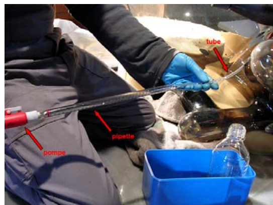
Fig.75 – Pipette (avec pompe) pleine de mercure extraite de l'ampoule et basculée vers l'arrière 493
