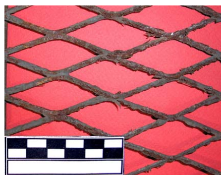
Fig.55 – Corrosion des grillages 467
