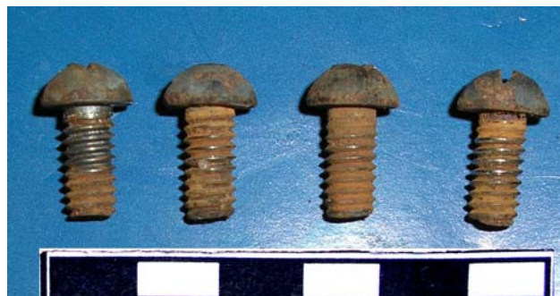
Fig.62 – Oxydation superficielle des filets de la visserie 474
