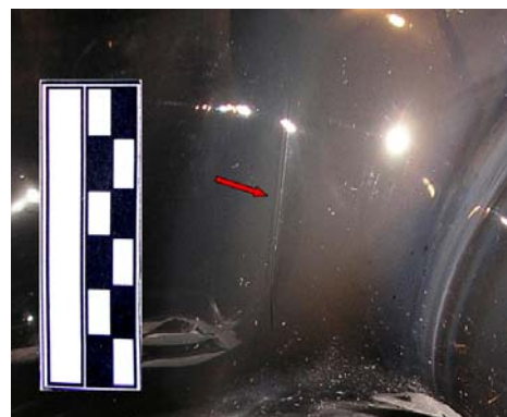
Fig.51 – Fissure à la base du bras de l'ampoule n°2 463
