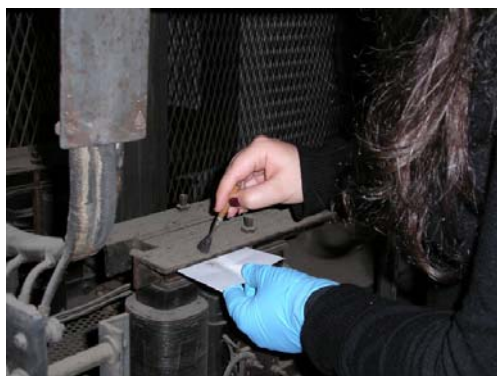
Fig.68 – Prélèvement de poussière à l'aide d'un pinceau et d'une feuille de papier 484
