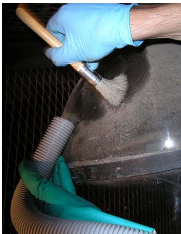
Fig.85 – Elimination des poussières sur l'ensemble de l'appareillage à l'aide de pinceaux et d'un aspirateur
