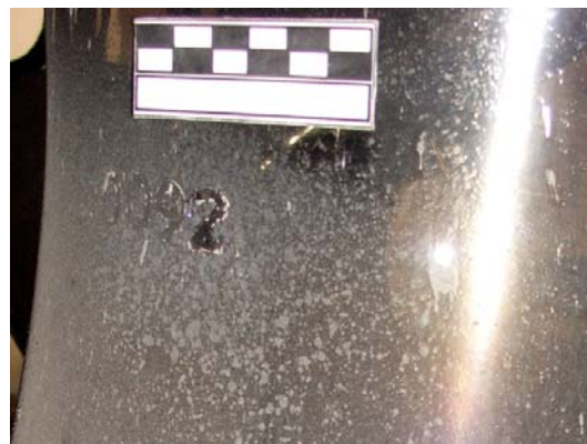
Fig.49 – Dépôt jaunâtre sur la surface du verre 460
