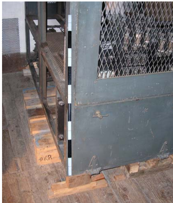
Fig.92 – Redresseur n°2 stabilisé à l'aide de poutres en bois 514
