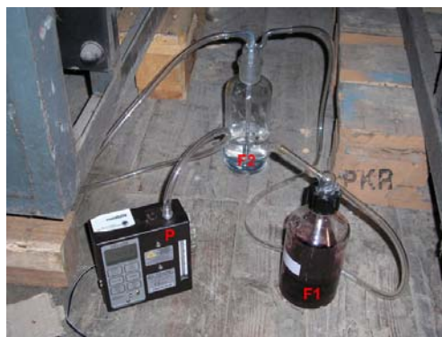
Fig.69 – Appareillage pour le prélèvement d'air 483
