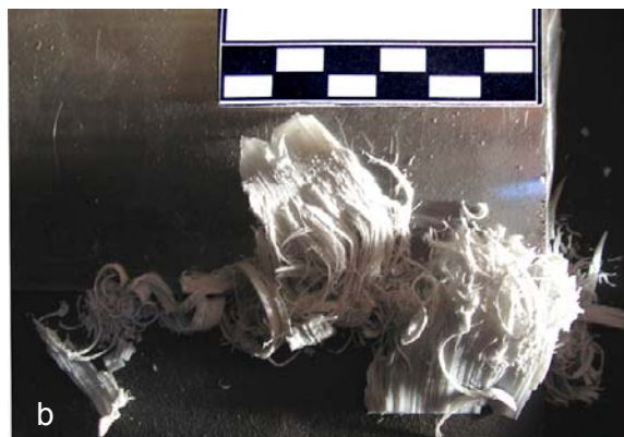
Fig.3 – Tranche de la plaque d'aluminium utilisée pour racler le fond de la boîte : a – après 15 min. / b – après 180 min.
