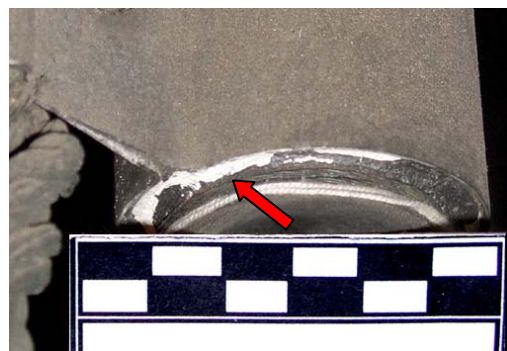
Fig.53 – Produit blanc au niveau de la liaison entre le bras en verre et la connexion électrique 465
