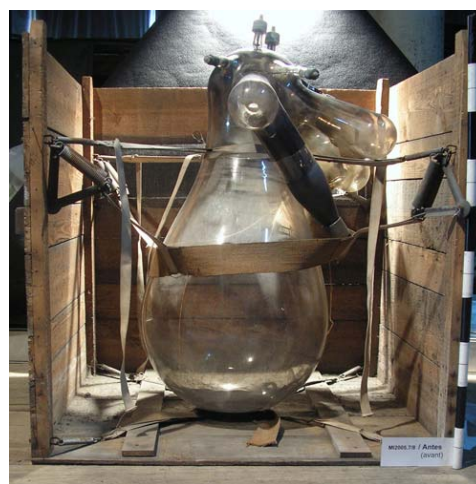
Fig.72 – Vue de profil de l'ampoule une fois l'un des côtés de sa boîte de stockage éliminé 490
