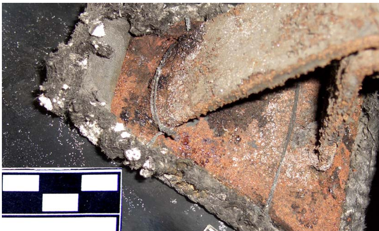
Fig.57 – Corrosions ferreuses d'une des pattes de soutien des ampoules 469
