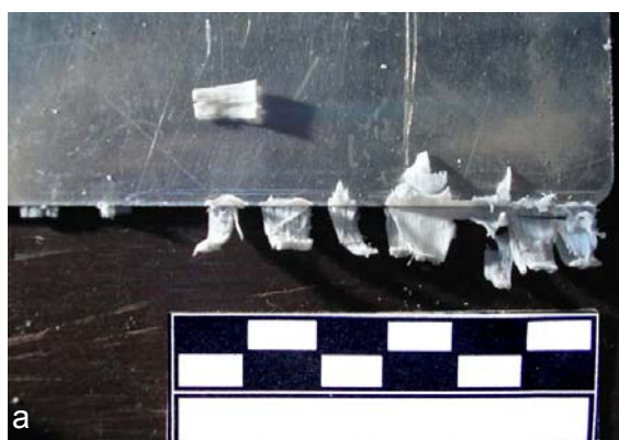
Fig.3 – Tranche de la plaque d'aluminium utilisée pour racler le fond de la boîte : a – après 15 min. / b – après 180 min.
