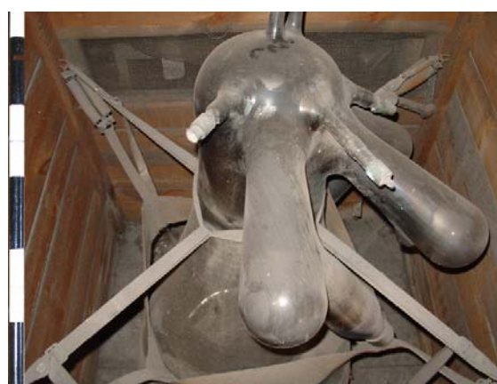
Fig.64 – Empoussièrément généralisé sur l'ampoule cassée 476
