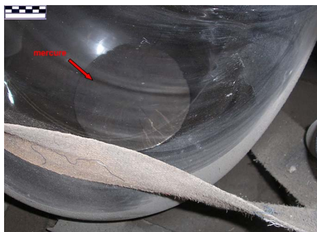
Fig.47 – Mercure identifié dans le fond de l'ampoule cassée 459
