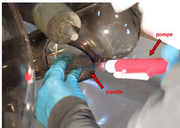
Fig.74 – Pompage du mercure en position horizontale 492
