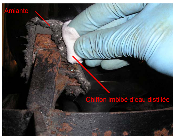
Fig.86 – Humidification des fibres d'amiante 507 508
