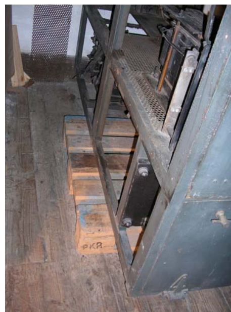
Fig.38 – Base de l'armoire n°2 : le centre uniquement repose sur une palette 450
