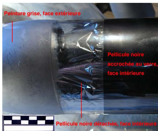
Fig.46 – Avant bras anodique 458
