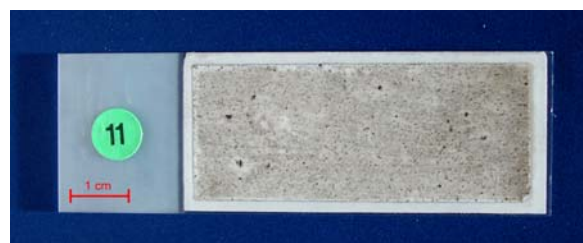
Fig.67 – Lamelle retournée (une deuxième étiquette blanche autocollante permet de maintenir en place l'étiquette portant la poussière) 481
