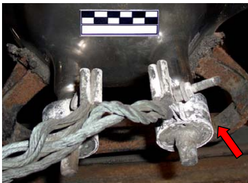
Fig.52 – Corrosion sur les chapeaux des connexions cathodiques 464
