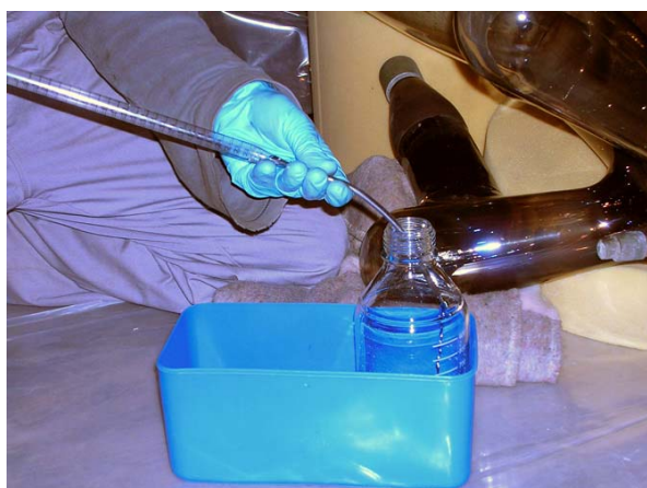
Fig.76 – Vidange de la pipette dans la bouteille en Pyrex® 494
