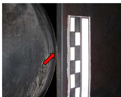
Fig.60 – Contact du bras en verre avec le panneau électrique 473
