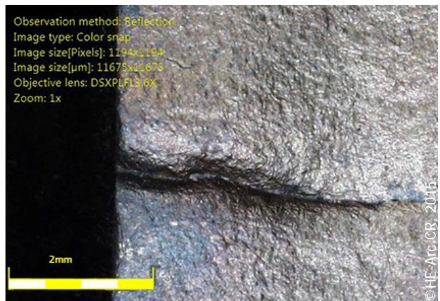
Figure 29 : Fissure de la couche métallique se profilant vers le centre de l'étiquette. (IId902.12).
