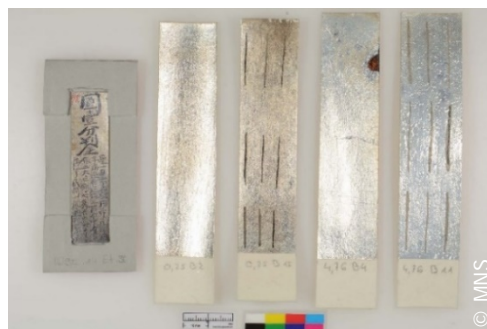
Figure 78 : Epreuves série B après traitement plasma.
