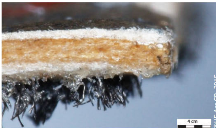
Figure 15 : Stratigraphie d'une étiquette depuis le bas : (reste de textile), papier japonais, carton, papier japonais et couche métallique.
