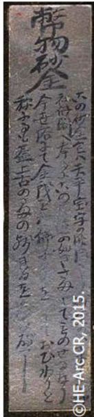
Figure 35 : Exemple d'un ternissement prononcé généralisé sur toute la surface de l'étiquette. (IIId902.28)
