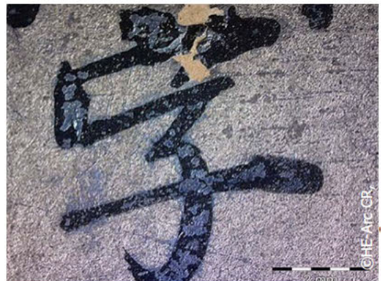
Figure 38 : Exemple où le ternissement qui se développe sous un idéogramme prend la place de l'encre.
