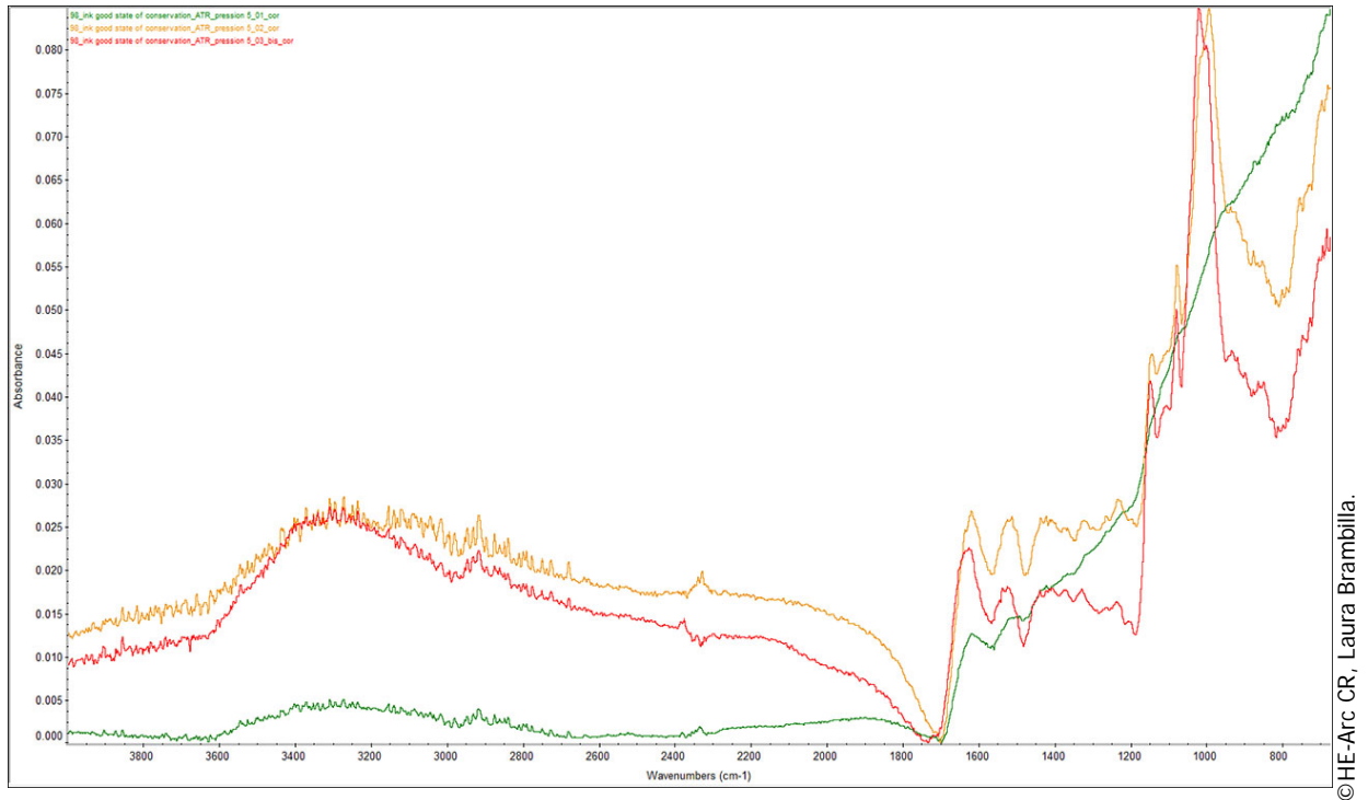
Figure 166 : Spectre IRTF en ART à pression 5, comparaisons de plusieurs pointés sur l'encre.
