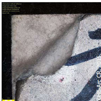
Figure 30 : Décollement du papier et de la couche métallique sur un coin de l'étiquette. (IId902.16).
