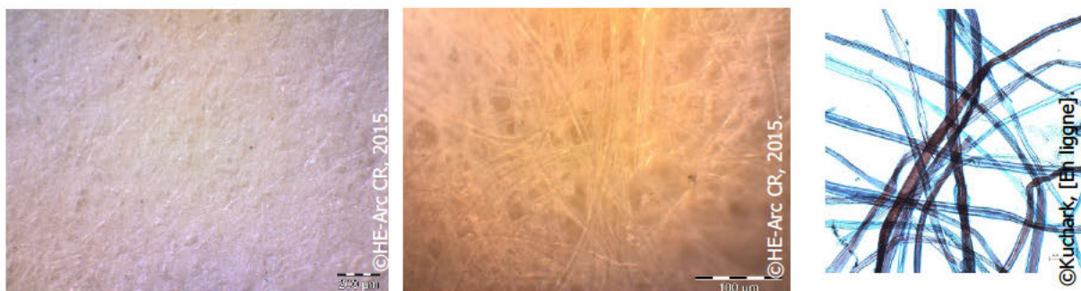
Figure 16 : Agrandissement des fibres du papier situé à l'arrière d'une étiquette et comparaison avec des fibres de référence du papier kozo (image de droite).
