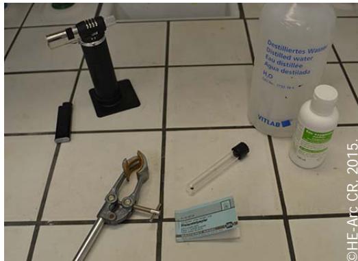
Figure 196 : Matériels pour le test à l'acétate de plomb
