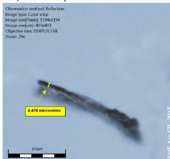
Figure 19 : Mesure de l'épaisseur de la couche métallique par le microscope numérique.
