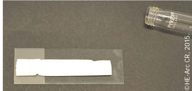
Figure 197 : Après pyrolyse de l'échantillon, le papier n'est pas coloré, ce qui exclut la présence de soufre dans le textile.
