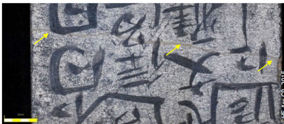
Figure 21 : Fissure jointive sur toute la largeur de l'étiquette (flèche jaune), comportement proche d'une feuille métallique.
