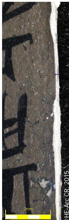
Figure 27 : Décollement de la couche métallique et du papier dans les bordures. (IId902.16)
