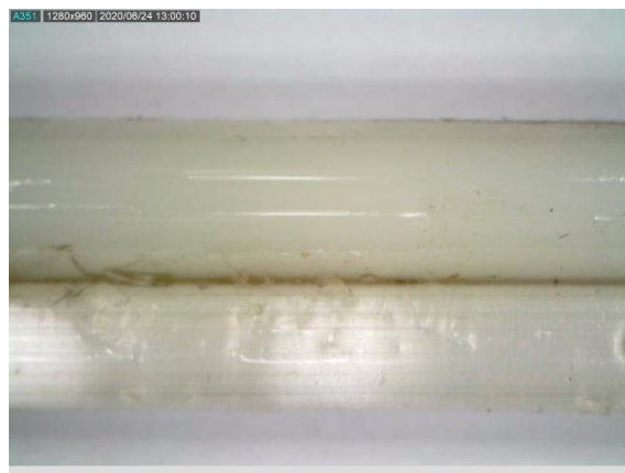
Fig. 154 : Après nettoyage à l'éthylène glycol
