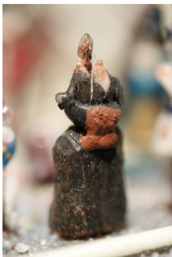
Fig. 118 : Corrosion à l'interface métal/verre
