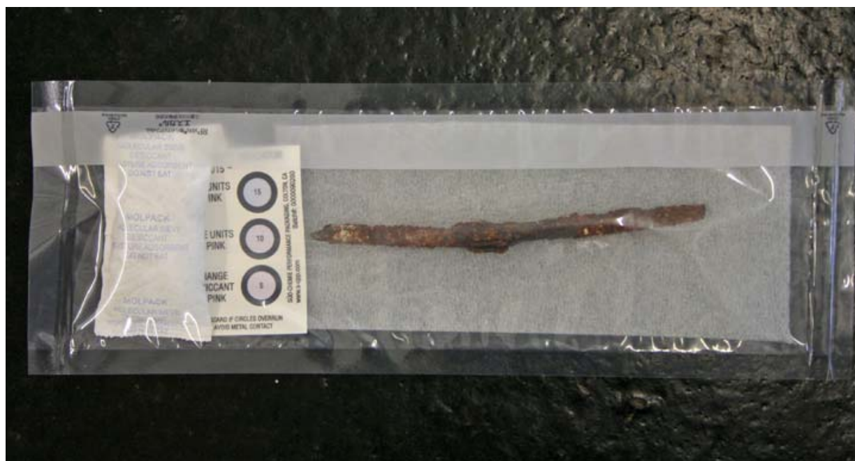
Fig. 18 : Objet soudé dans une poche étanche avec tamis moléculaire
