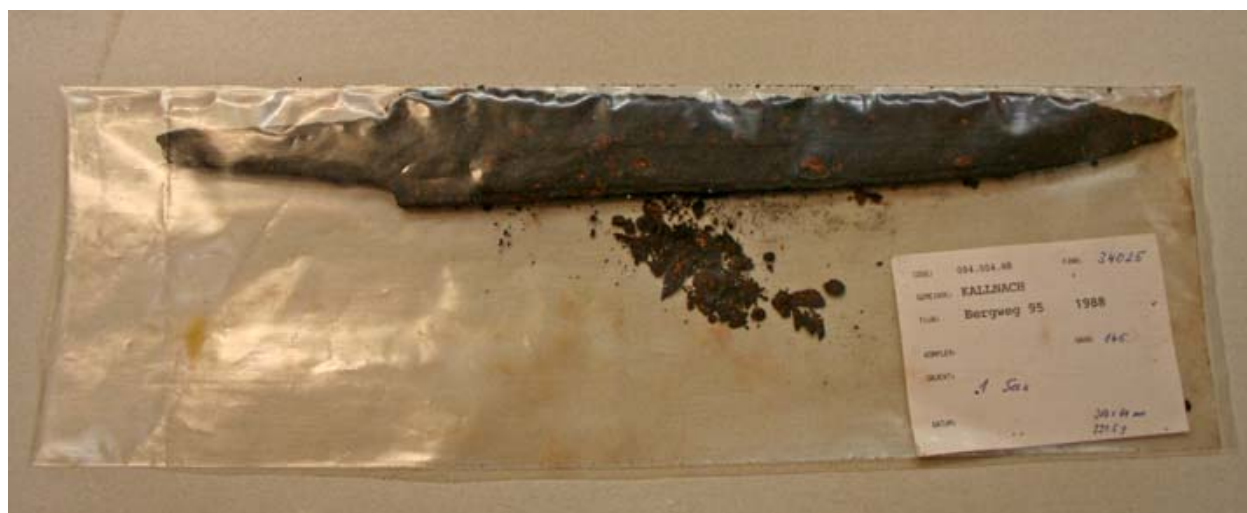
Fig. 13 : Objet atteint de corrosion active
