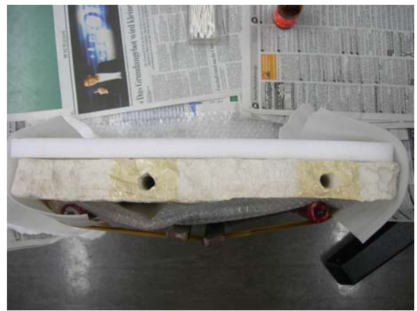
Abbildung 108: Vor dem Anbringen der Dübel wurde die Umgebung der Dübellöcher mit Gummimilch geschützt.
