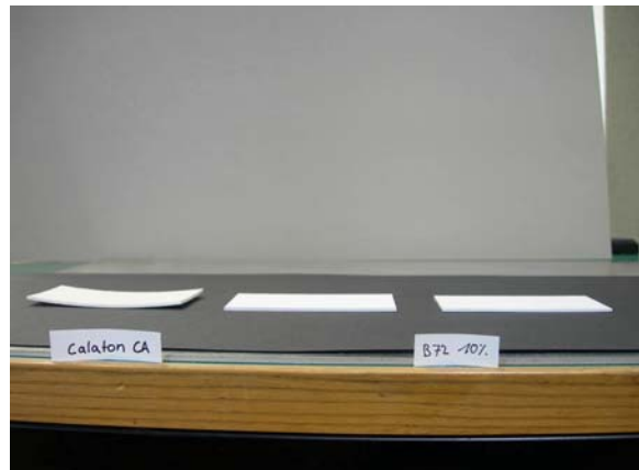
Abbildung 74: Links aussen befindet sich die Referenzprobe mit Calaton® CA. Daneben sieht man die unveränderten Proben mit Paraloid® B72.
