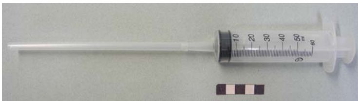
Abbildung 112: 50 ml Plastikspritze mit Aufsatz, welche für die Injizierung der Epoxydharzmasse in horizontal liegende Dübellöcher verwendet wurde.
