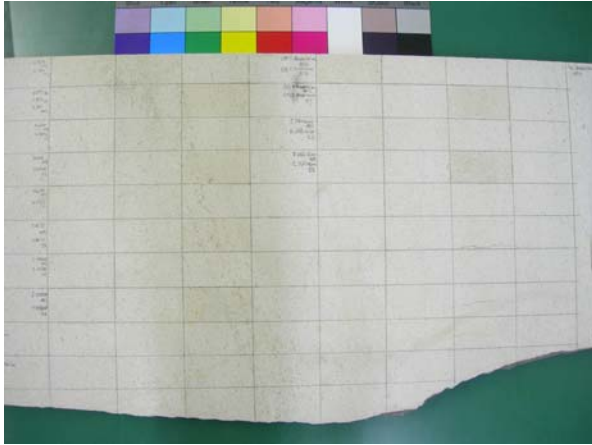
Abbildung 77: Testfelder für die Evaluation von Glanz und Farbveränderung.
