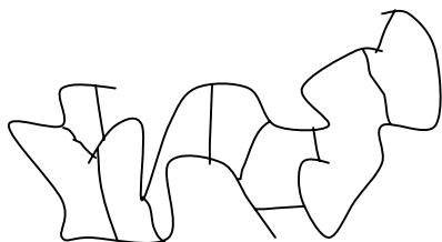
Abbildung 28 : Vernetzter Duroplast.
