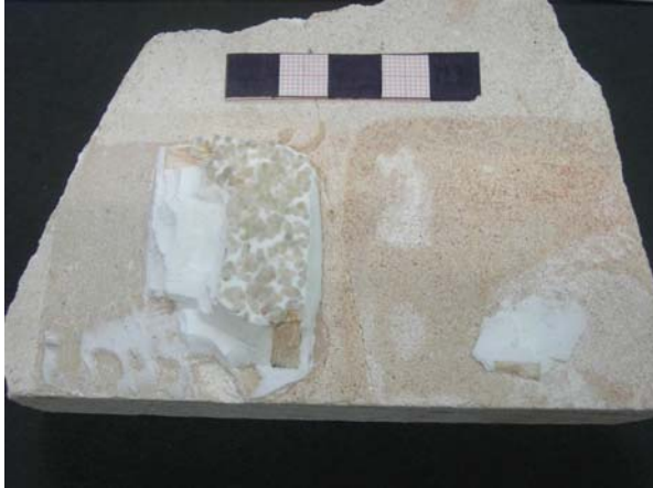
Abbildung 102: Auf der gut isolierten Fläche rechts liess sich das Epoxydharz vollständig entfernen. Links konnte das Harz hingegen nur bis auf die Oberfläche abgeschabt werden und verblieb im Stein.
