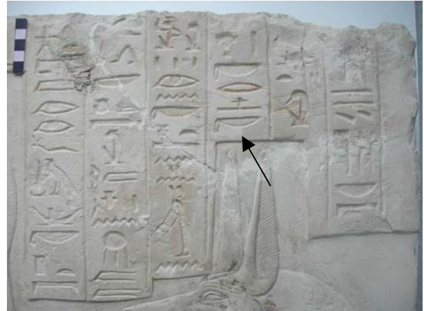
Abbildung 69: Detailaufnahme in der linken oberen Ecke des Fragmentes 2. Trotz der anderen Beleuchtung als in Abb. 1 ist zu erkennen, dass die Gesteinsoberfläche während 22 Jahren praktisch unverändert geblieben ist. Oberhalb des rechten Ohrs des Anubis fehlt etwas mehr des Filmes aus flüssigem Nylon, da an dieser Stelle Probenmaterial manuell mit einem Skalpell entfernt wurde (Probe 4).
