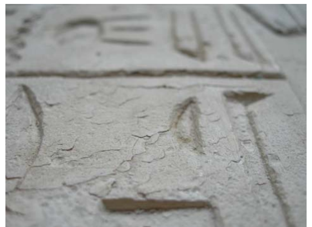
Abbildung 127: Oberfläche des Fragmentes 2 nach dem Herunterkleben der Schollen mit Primal® AC 33.
