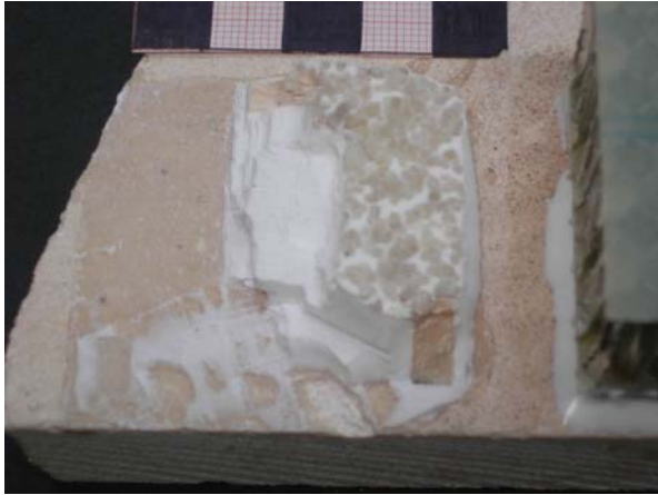
Abbildung 96: Nach dem Abbrechen der Wabenplatte verblieben das Epoxydharz-Hohlglaskugelmisch, die Sandkörner und die Abstandhalter aus Balsaholz auf dem Stein.
