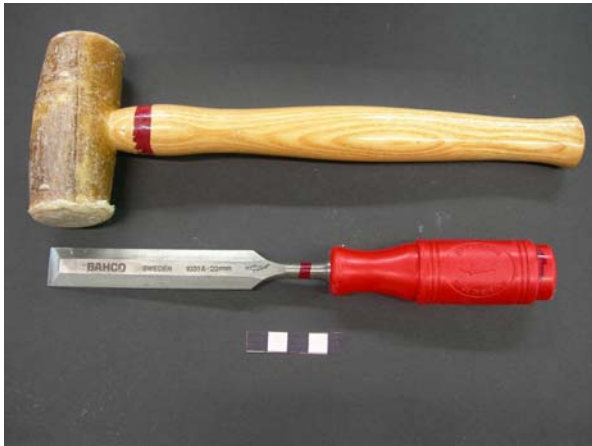
Abbildung 100: Stechbeitel und Gummihammer welche verwendet wurden um die auf dem Stein verbleibende Epoxydharzmasse herunter zu arbeiten.
