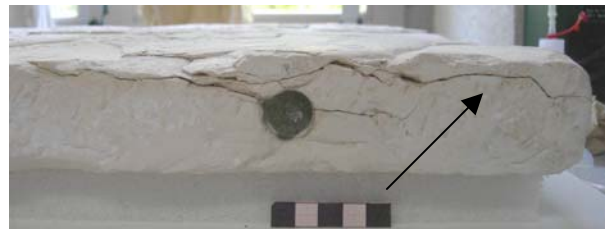
Abbildung 114: Rechte Ecke der unteren Seite nach dem Verkleben des Dübelloches. Der Durchmesser der Risse nahm minimal zu (siehe Pfeil).
