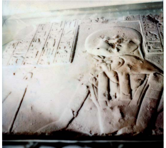
Abbildung 16: Zwischenzustandsaufnahme des Fragmentes n° 2 während der Entsalzung. Die Blasenbildung an der Oberfläche ist eindrücklich zu erkennen.
