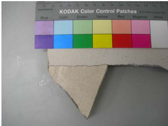
Abbildung 79: Probestück nach der Behandlung mit flüssigem Nylon mit angrenzendem unbehandeltem Gestein. Nach der Konsolidierung mit flüssigem Nylon wurde das Gestein sichtlich dunkler.
