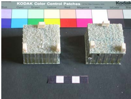
Abbildung 93: Vorbereitete Probeträger mit 5 mm dicken Distanzhaltern aus Balsa.
