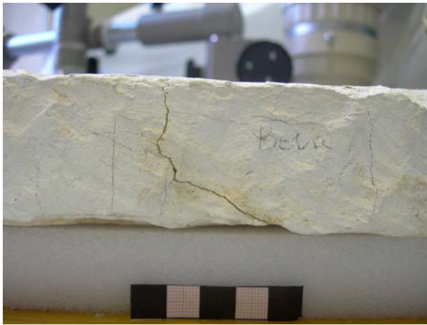
Abbildung 24: Bruchverlauf auf der linken Seite des Fragmentes 1 auf der Höhe des Kopfes der Göttin Hathor.
