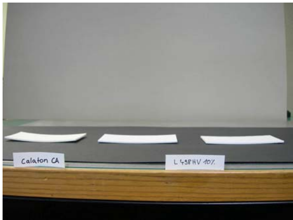
Abbildung 73: Links aussen ist die stark verbogene Probe mit Calaton® CA zu sehen. In der Mitte und rechts aussen befinden sich die leicht verbogenen 10%igen Proben von Lascaux® 498 HV.
