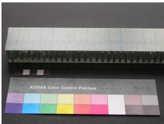
Abbildung 91: Unbehandelter Abschnitt einer Wabenplatte der Flugzeugwerke Emmen.
