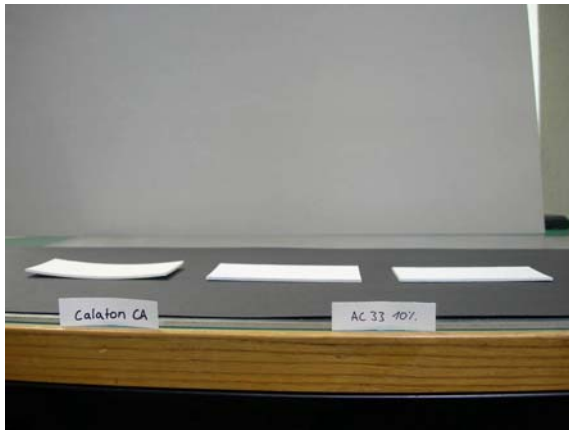
Abbildung 72: Primal® AC 33 zeigt keine sichtbare Veränderung. Links aussen befindet sich zum Vergleich die Probe mit Calaton® CA.
