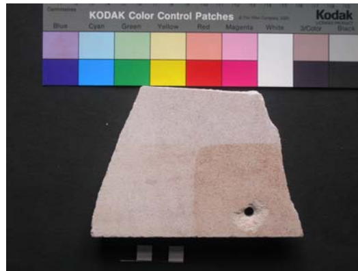
Abbildung 94: Vorbereitete Steinplatte. Rechts ist die mehrfach isolierte Fläche und links die nur schwach isolierte Fläche erkennbar.
