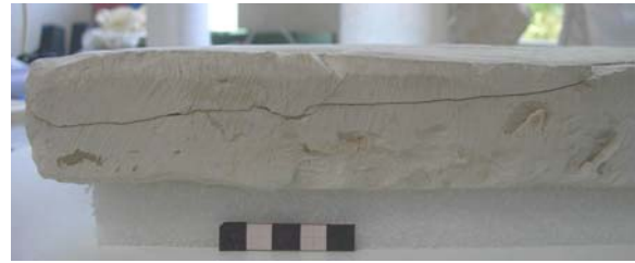
Abbildung 39: Rissverlauf am unteren Rand der rechten Seite des Fragmentes 2.
