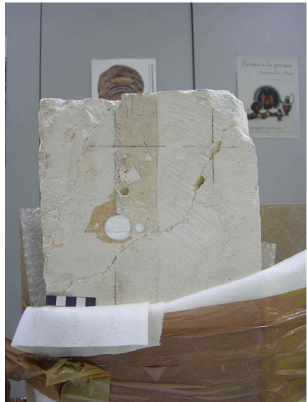
Abbildung 111: Dübellöcher nach der Verklebung.
