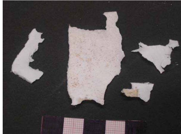
Abbildung 103: Die ausgedünnten ca. 1 mm dicken Epoxydharzschichten nach dem Ablösen. Zu sehen ist, dass einzelne Gesteinspartikel der Oberfläche mit abgelöst wurden. Diese Beschädigung ist jedoch gering und ist sehr wahrscheinlich auf eine nicht ganz vollkommene Isolierung zurück zu führen.
