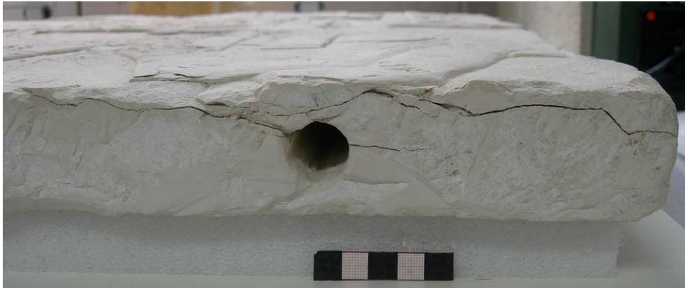
Abbildung 23: Sehr ausgeprägte Risse an der rechten unteren Ecke des Fragmentes 2. Diese verlaufen parallel zur Oberfläche und überlagern sich teilweise.
