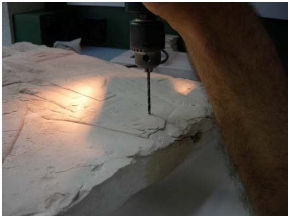
Abbildung 121: Bohrung der Infiltrationslöcher.
