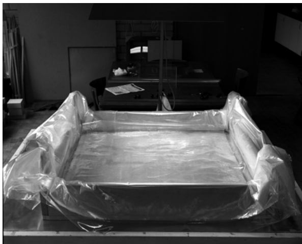
Abbildung 13: Das nicht zerlegte Relief während der Behandlung im gewärmten Calatonbad. Das Bad wurde mit einer Folie abgedeckt, um ein Verdunsten des verwendeten Wasser/Methanolgemisches so gering wie möglich zu halten. Bildquelle: WELSCH, zwischen dem 26.07.1978 und dem 01.08.1978.
