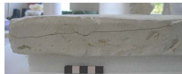
Abbildung 116: Die selbe Ansicht wie in Abb. 115 nach dem Verkleben. Die Ausdehnung des Rissdurchmessers ist auf der Photographie nicht erkennbar.
