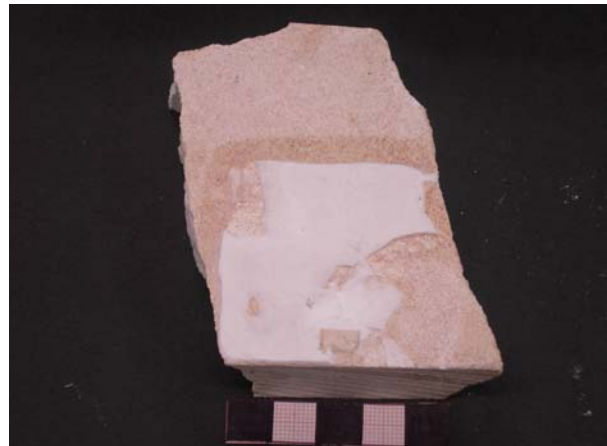
Abbildung 101: Ausgedünnte Epoxydharzmasse. Diese ist hier nur noch ca. 1 mm dick.
