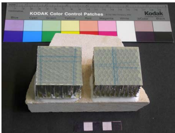
Abbildung 95: Mit dem Stein verklebte Wabenplattenfragmente.
