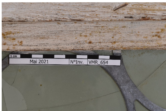
Figure 109 : VMR_654, résidus organiques avant nettoyage
