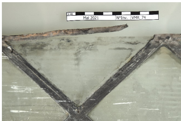
Figure 28 : VMR_74, cassure et déformation du sertissage en plomb
