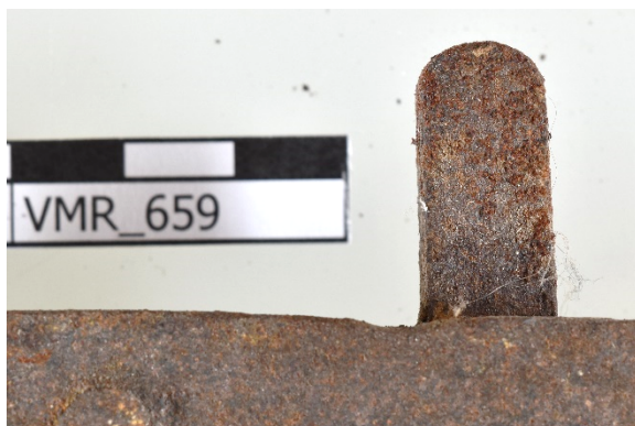
Figure 30 : VMR_659, piqûres de corrosion du fer
