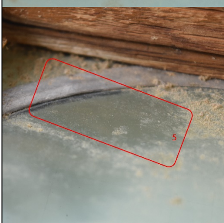
Figure 87 : VMR_654, zone de test après nettoyage : Smoke Sponge
