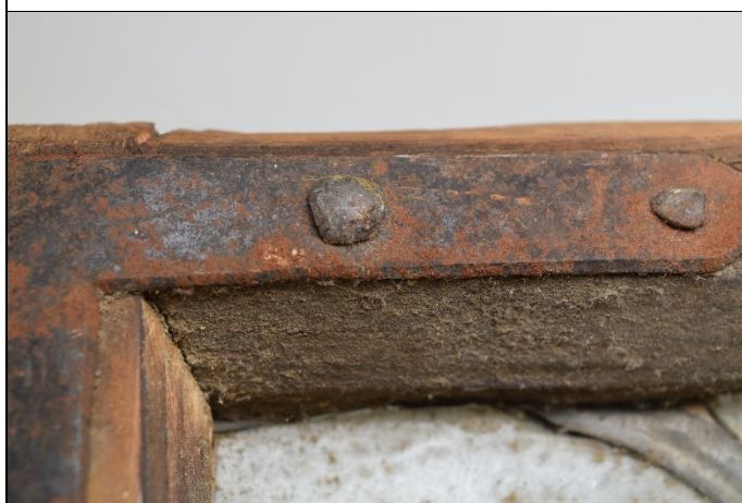
Figure 91 : VMR_654, après nettoyage à la gomme Wishab molle, grossissement 40x
