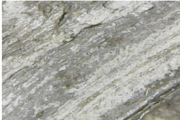
Figure 34 : VMR_723, corrosion du plomb, grossissement env. 220x
