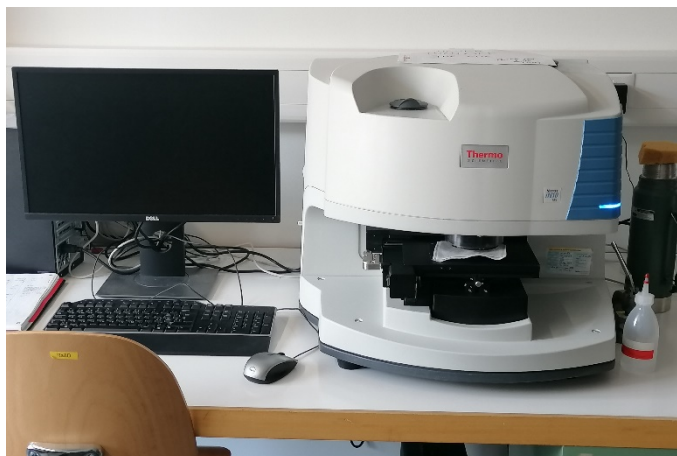
Figure 51 : Système d'analyse FTIR, dans la HE-Arc
