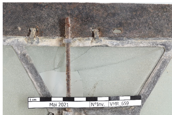
Figure 33 : VMR_659, produits de corrosion blancs du plomb
