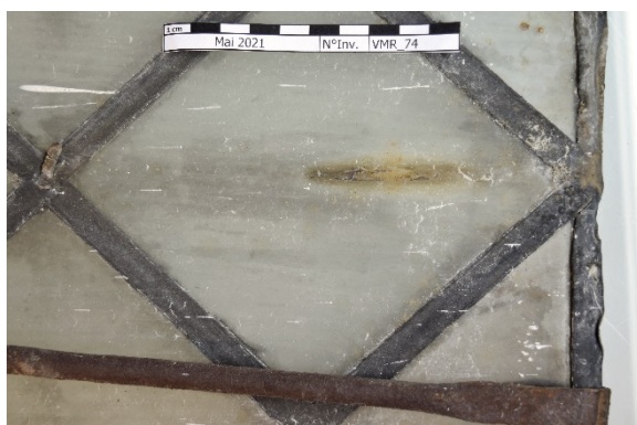
Figure 103 : VMR_74, tache de corrosion, avant nettoyage
