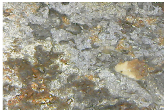
Figure 31 : VMR_10054, cratères de corrosion du fer, grossissement env.220x
