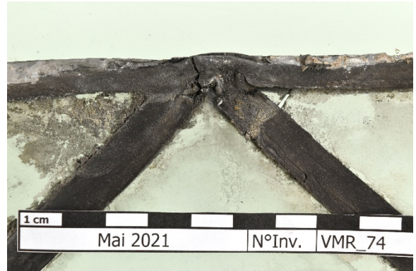
Figure 35 : VMR_74, produits de corrosion noirs du plomb
