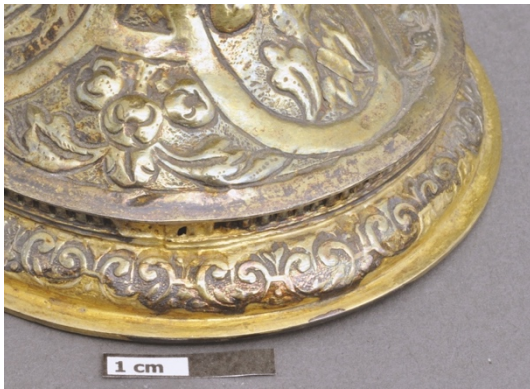
Abbildung 62 Fuss mit nicht korrodierten Lotflecken und eingefressenem Lot
