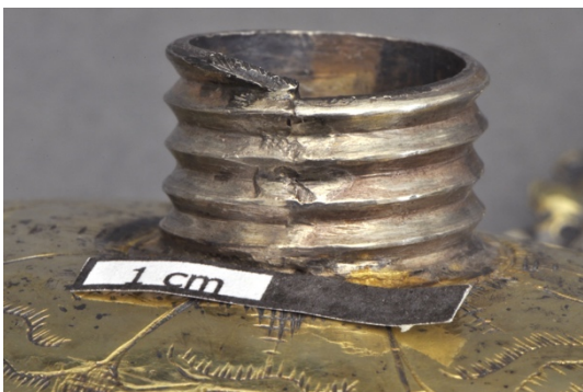
Abbildung 50 Gefeiltes Gewinde der Fassung mit Lötfläche
