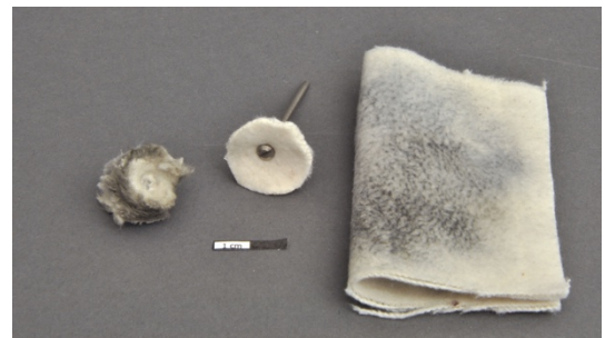
Abbildung 86 Mandrel mit Baumwollmoltonrondellen und Baumwollmolton
