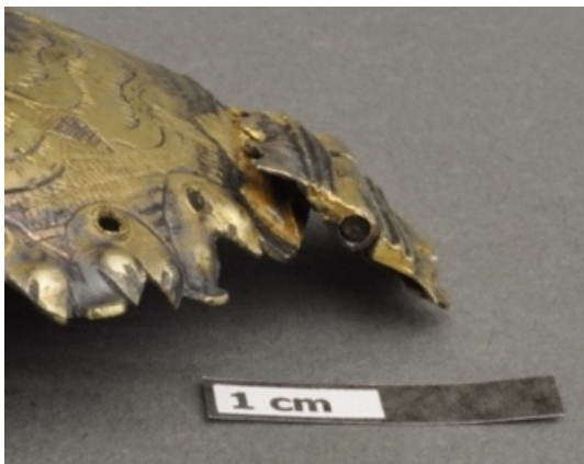
Abbildung 60 teilweise Abgelötete Scharnierverbindung der Bugspange
