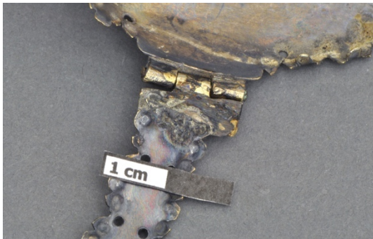
Abbildung 49 Gewinkelt positionierte Seitenspanne mit Weichlötung
