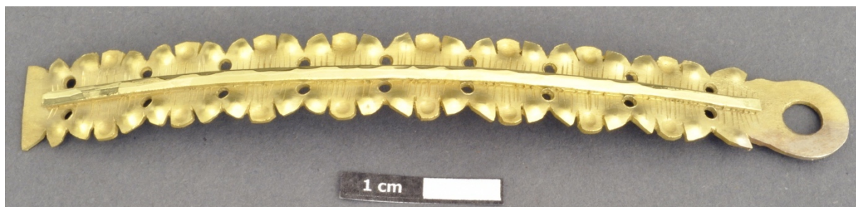
Abbildung 77 Versuchsspange feuervergoldet und poliert, Vorderseite
