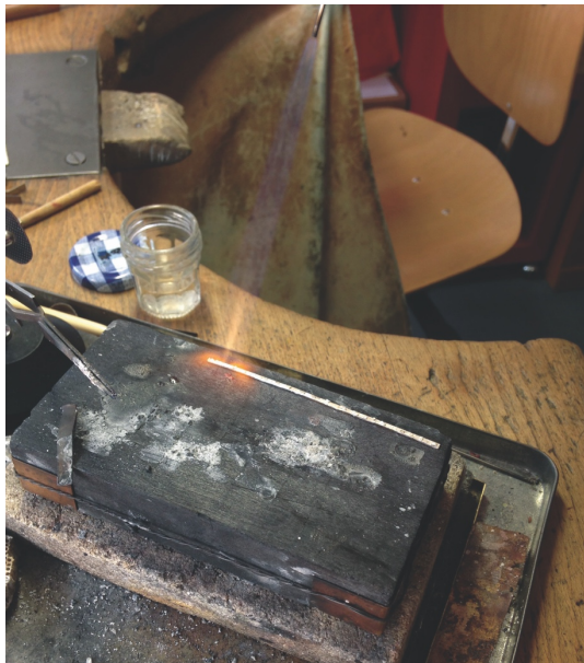
Abbildung 79 Aufschwemmen der Lotpailleten auf das Mittelprofil der Versuchsspange
