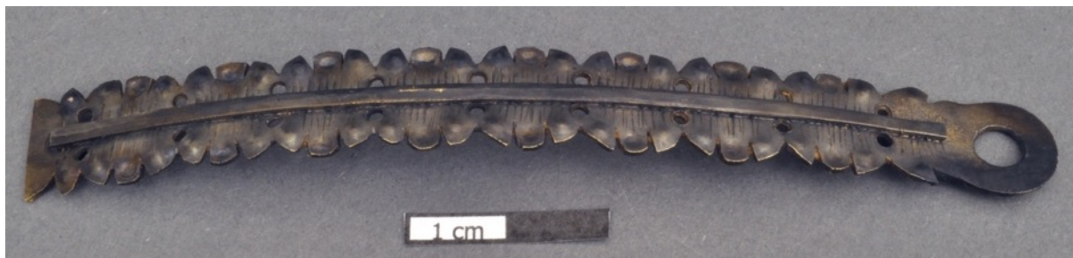
Abbildung 75 Versuchsspange, feuervergoldet, poliert und geschwärzt, Vorderseite
