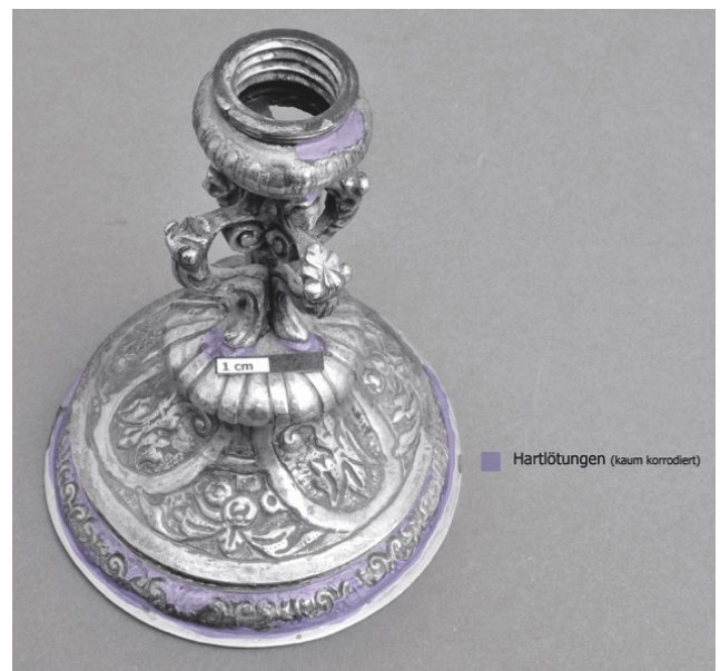
Grafik 16 Kartierung der korrosionsbeständigen Hartlötungen (violett) am Schaft und am Fuss
