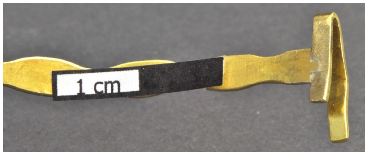
Abbildung 22 Die Halterung der Heckspange mit der sichtbaren Feilung für die Führung beim Löten
