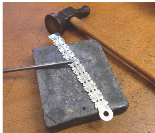
Abbildung 80 Punzieren der Akanthusblätter mit einem gerundeten Punzen und dem Ziselierhammer
