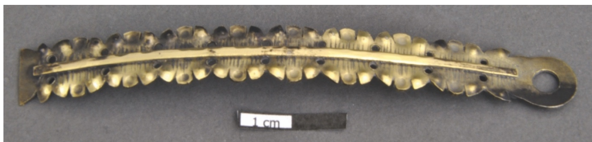
Abbildung 78 Versuchsspange mit freigelegten Testbereichen
