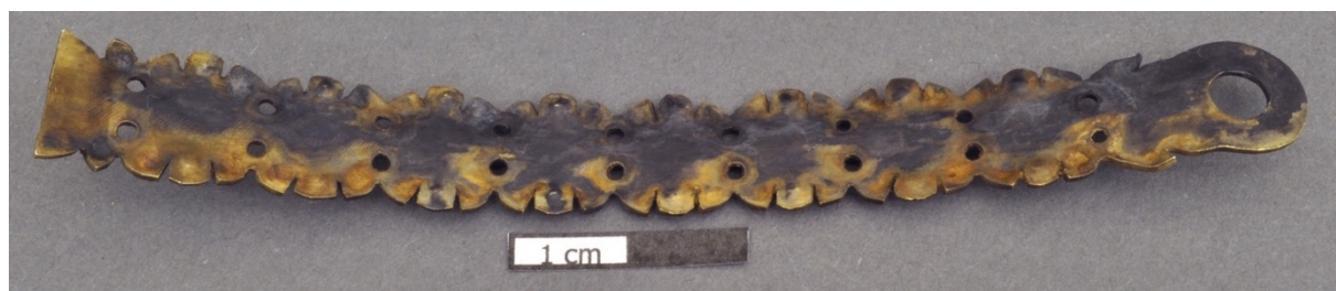
Abbildung 76 Versuchsspange feuervergoldet und geschwärzt, Rückseite
