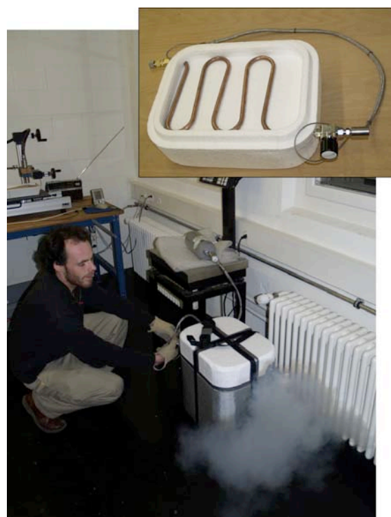
FIG. 43 – Couvercle de test de l'option du gaz carbonique.
