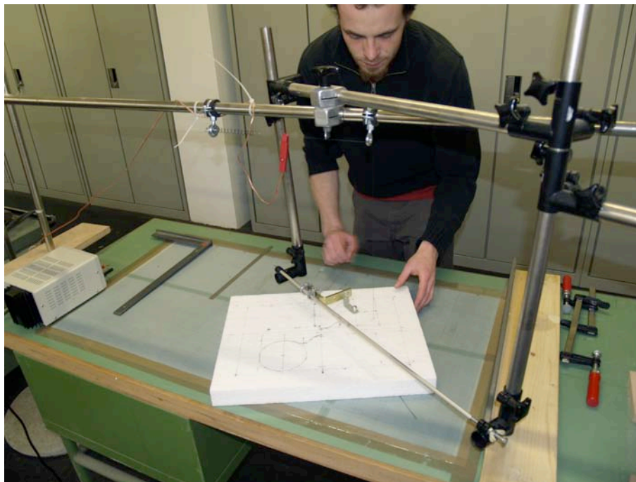
FIG. 34 – Installation de découpe du PSE – A relever la présence du ressort de tension qui permet la réalisation de coupes propres, évitant de répercuter la moindre interruption de mouvement.
