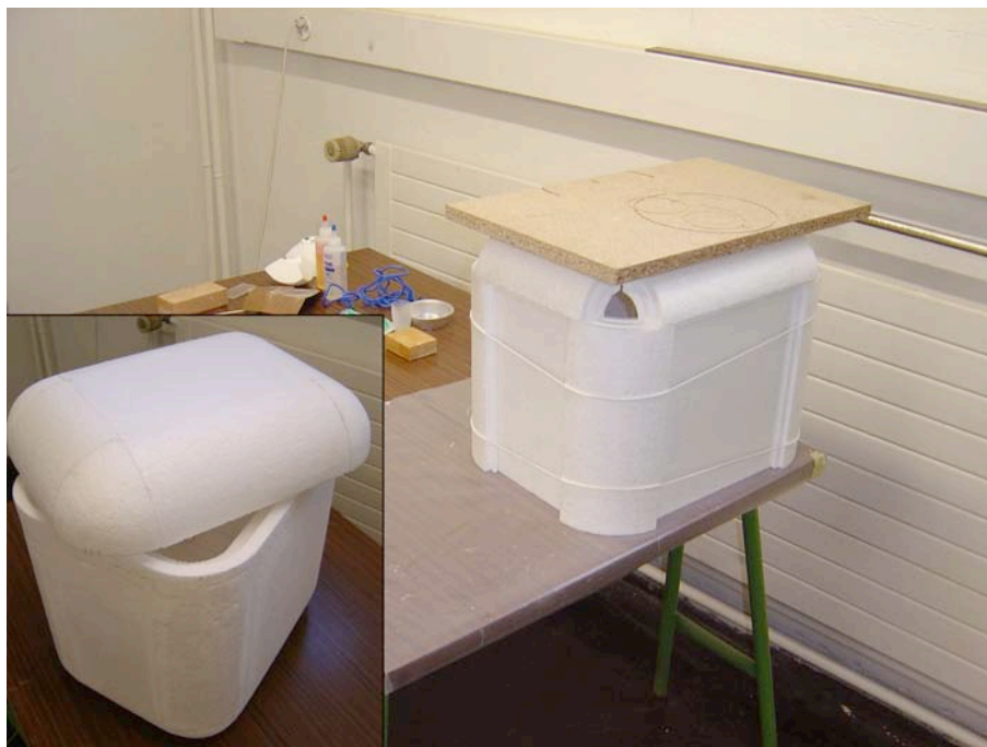
FIG. 35 – Caisson isotherme – Ame isolante & Etape de collage.
