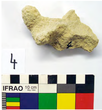
Photo 62: Echantillon de roche n°4, prélevé au sol entre les poteaux 15 et 16. Il vient vraisemblablement d'une zone alvéolée.
