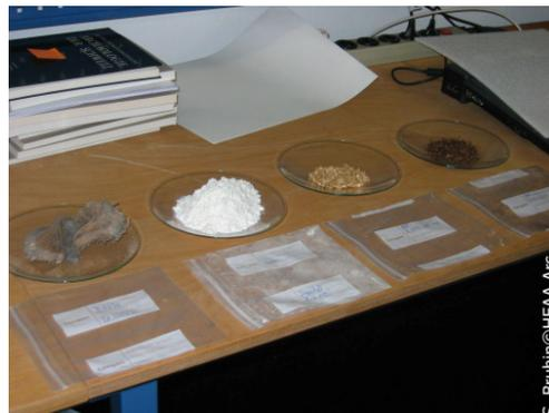
Die vier Proben wurden mit einer Pipette komplett mit ca. 100g CDAN-Schmelze bedeckt. Danach liess man das CDAN bei 58°C im Wärmeschrank sublimieren (s. Abb. 59 bis Abb. 61)
