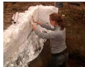
*Auftragen der Verstärkung aus synthetischem Gips*
