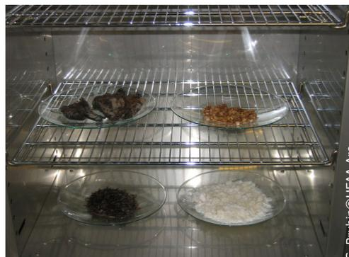
*Abb. 61 : Holzprobe nach der beschleunigten Sublimation*
