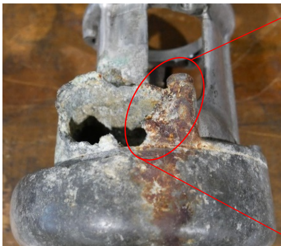
Figure 35: Pompe à eau HSx a, pipe corrodée et des traces de produits ferreux.
