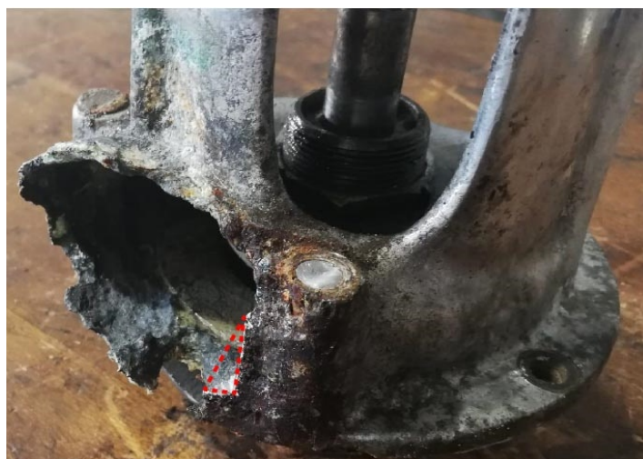
Figure 54: Zone de prélèvement pour la coupe du corps de pompe à eau HSx a, en rouge.
