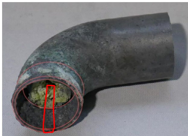
Figure 47 : Zone de prélèvement pour la coupe de la pipe bouchée de Bx, en rouge épais.
