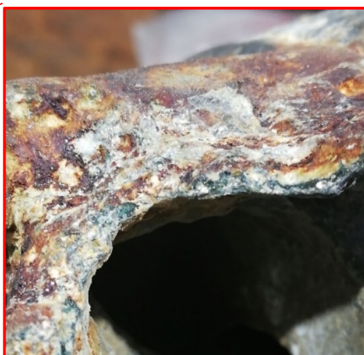
Figure 34: Détail de la pipe de sortie de la pompe HSx a.
