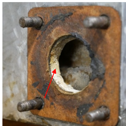
Figure 9: Dépôt dans les doubles parois de la boîte à cames B37, visuellement accessibles après le retrait d'une pipe.
