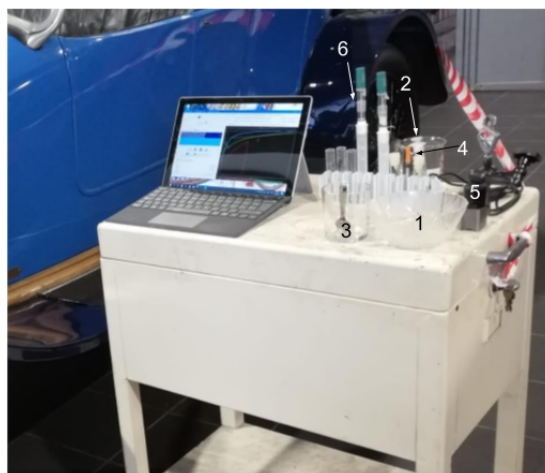
Figure 66: Matériel pour les mesures DiscoveryMat transporté à proximité du véhicule sur table roulante.
