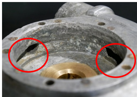
Figure 13: Erosion des ouvertures internes de la pompe à eau B37.
