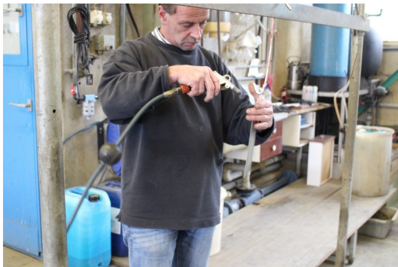
Figure 27 : Séchage de la pièce après un dernier rinçage dans l'eau chaude. ©EG, He-arc CR 2017
