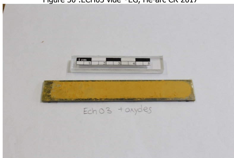
Figure 31 : ECH03 avec oxydes ©EG, He-arc CR 2017
