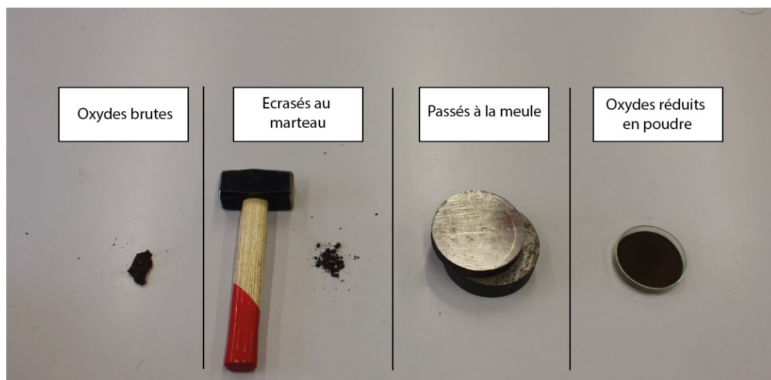
Figure 35 : Réduction des oxydes en poudre ©EG, He-arc CR 2017
