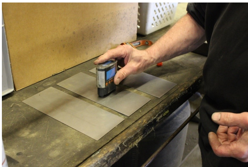
Figure 19 : Calibration de l'électroaimant pour évaluer l'épaisseur d'étain ©EG, He-arc CR 2017
