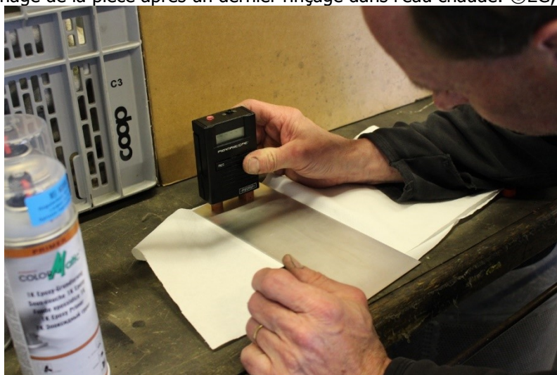
Figure 28 : Vérification de l'épaisseur avec un deuxième appareil calibré. ©EG, He-arc CR 2017
