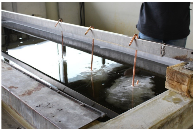
Figure 21 : dégraissage chimique et neutralisation de la surface. ©EG, He-arc CR 2017
