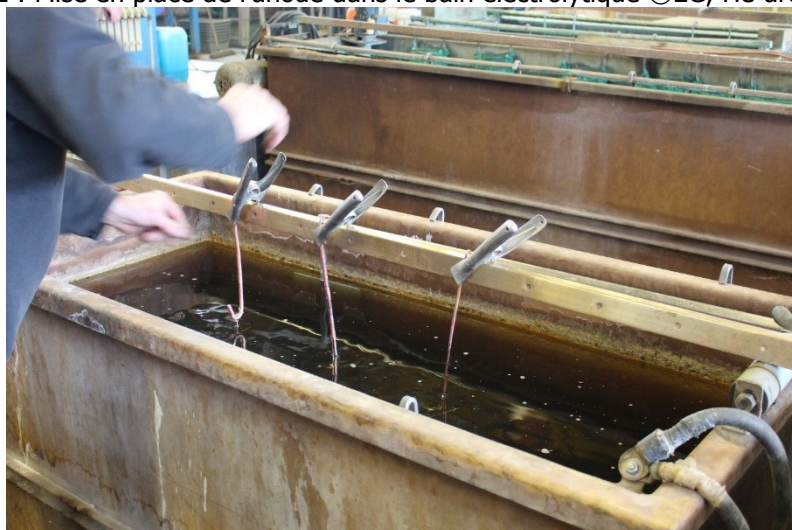
Figure 23 : Bain électrolytique ©EG, He-arc CR 2017
