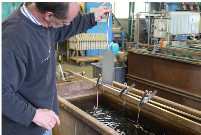
Figure 24 : Sortie de la plaque après le temps de dépose. ©EG, He-arc CR 2017
