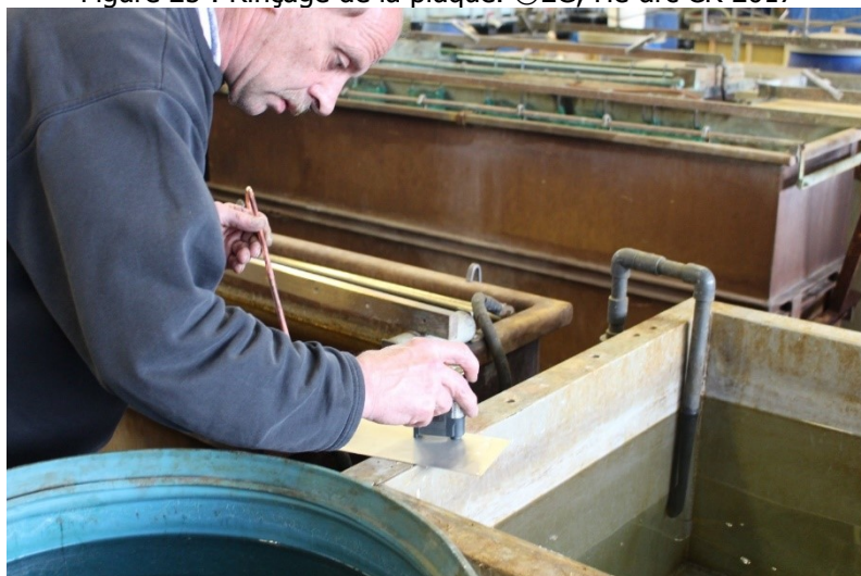
Figure 26 : Vérification de l'épaisseur par plusieurs points de mesures. ©EG, He-arc CR 2017
