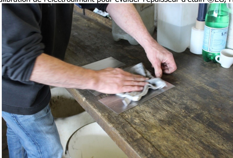
Figure 20 : Dégraissage des plaques ©EG, He-arc CR 2017
