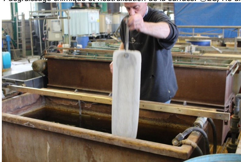
Figure 22 : Mise en place de l'anode dans le bain électrolytique ©EG, He-arc CR 2017
