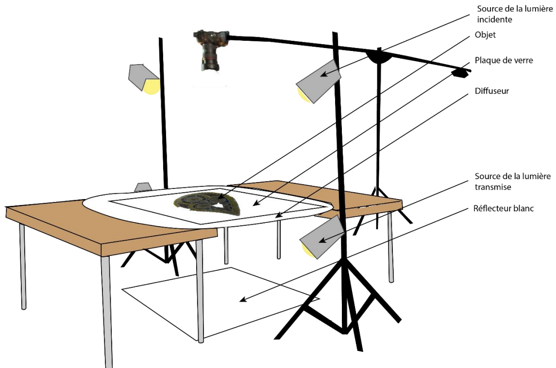
sch. 10 installation permettant des prises de vue des vitraux sous lumières transmises et incidentes
