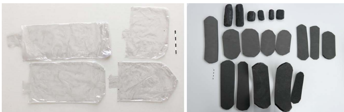
Figure 34- Exemple de structure gonflable (à droite), et différents formats de bandes de mousses polyéthylène
