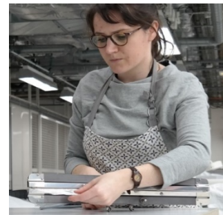
Figure 33-Thermosoudure du film PVC
