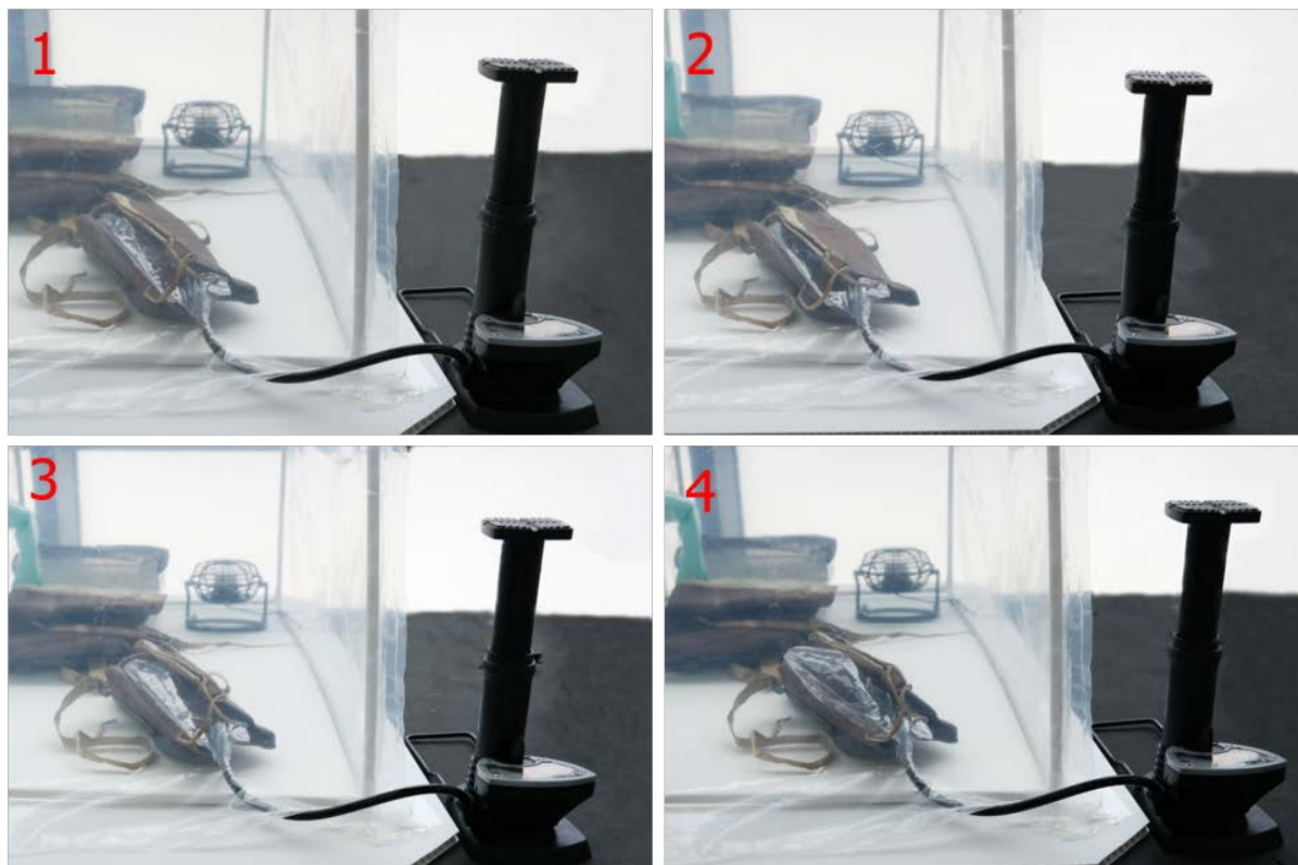
Figure 53- Différentes étapes de gonflement d'une structure placée dans un pli à l'extérieur d'une botte Tchouktche lors de son humidification en enceinte humide
