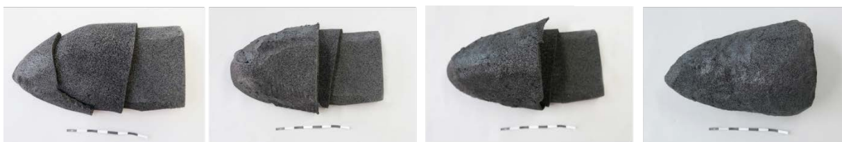
Figure 59- Différentes étapes de confection de supports pleins par thermosoudages progressifs de plusieurs formes
