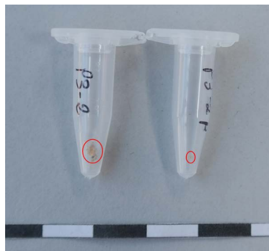
Figure 66- Prélèvement pour IFTR, pH et DSC (à gauche), et pour analyse protéomique (à droite)
