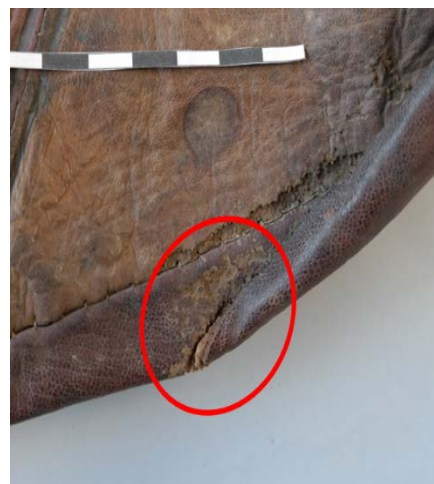
Figure 22- Fracture associée à la rigidité et à la déformation du cuir de la semelle de la chaussure 1 du Bénin
