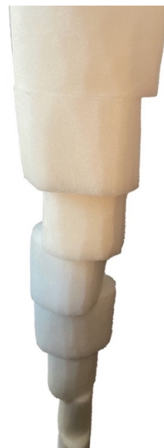
Figure 73 Blocs de mousse enfilés sur le tube en aluminium et collés avec de la colle thermofusible. © HE-Arc, MP Mottaz, 2020.
