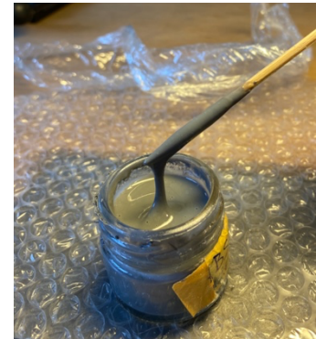
Figure 70 Pâte d'ABS dissous dans de l'acétone. © HE-Arc, MP Mottaz, 2020.
