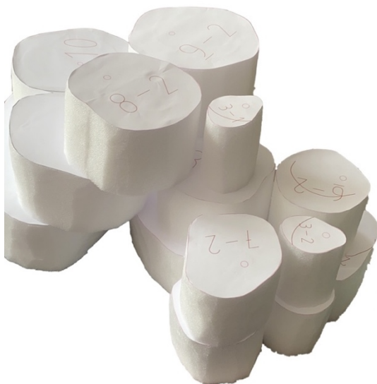
Figure 72 Blocs de mousse coupés selon les patrons. © HE-Arc, MP Mottaz, 2020.
