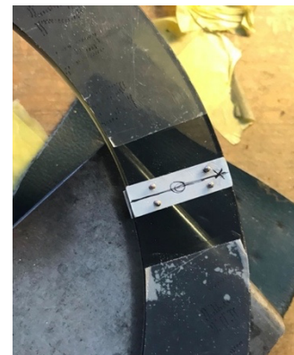
Figure 86 Goupillage des anneaux avec plaquettes et goupilles en argent 925. © HE-Arc, MP Mottaz, 2020.
