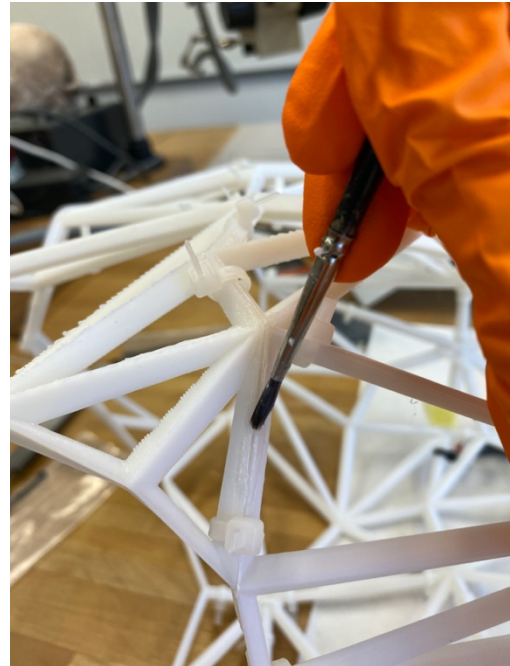
Figure 82 Collage de pièces blanches à l'acétone. © HE-Arc, MP Mottaz, 2020.
