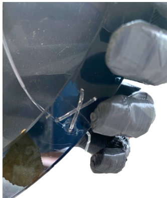
Figure 87 Ligature de l'anneau avec du fil nylon. © HE-Arc, MP Mottaz, 2020
