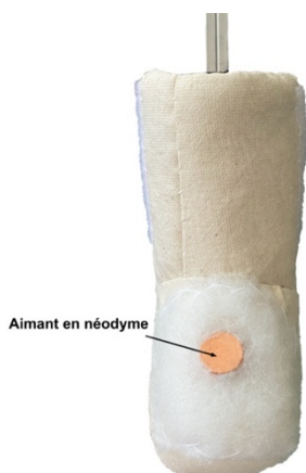
Figure 79 Aimant en néodyme collé sur le talon et dissimulé dans le ouatinage. © HE-Arc, MP Mottaz, 2020.
