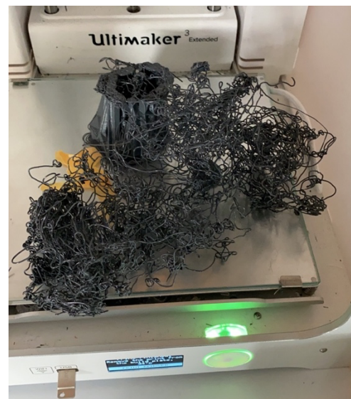
Figure 69 Exemple d'impression ratée en ABS : la pièce s'est décollée du plateau puis s'est déplacée, emportée par les va-et-vient de la buse d'impression. Les dernières couches de polymères se sont donc déposées dans le vide, créant ces frisures. © HE-Arc, MP Mottaz, 2020.
