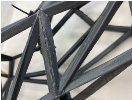
Figure 71 Collage et comblement des pièces par ajout d'une pâte composée d'ABS dissous dans de l'acétone. © HE-Arc, MP Mottaz, 2020.
