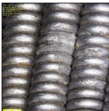
Figure 38 : Corrosion par piqure généralisée, ©C. Despland, HE-Arc
