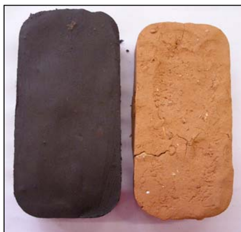
Fig. 6 : Retrait des éprouvettes après cuisson
