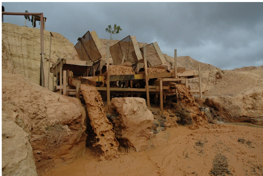
Fig.16 : Installation de séparation gravimétrique de graviers issus d'une exploitation alluviale de rubis et de saphirs, Ilakaka, Madagascar. (Photo : A.Respinger)
