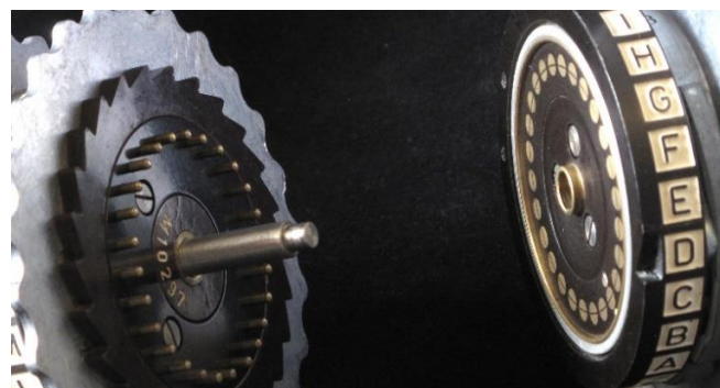
Figure 6 : Contacts électriques sur les rotors d'une machine Enigma
