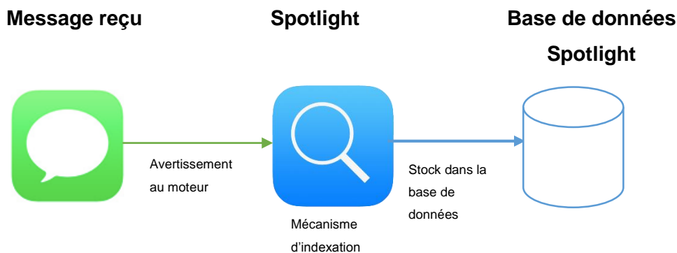
Figure 23 : Mécanisme d'indexation de Spotlight
