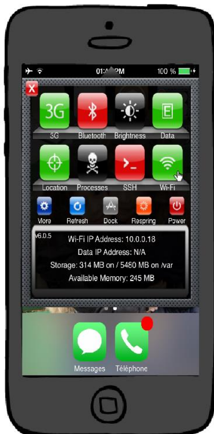
Figure 27 : Activation de SSH sur iPhone jailbreaké
