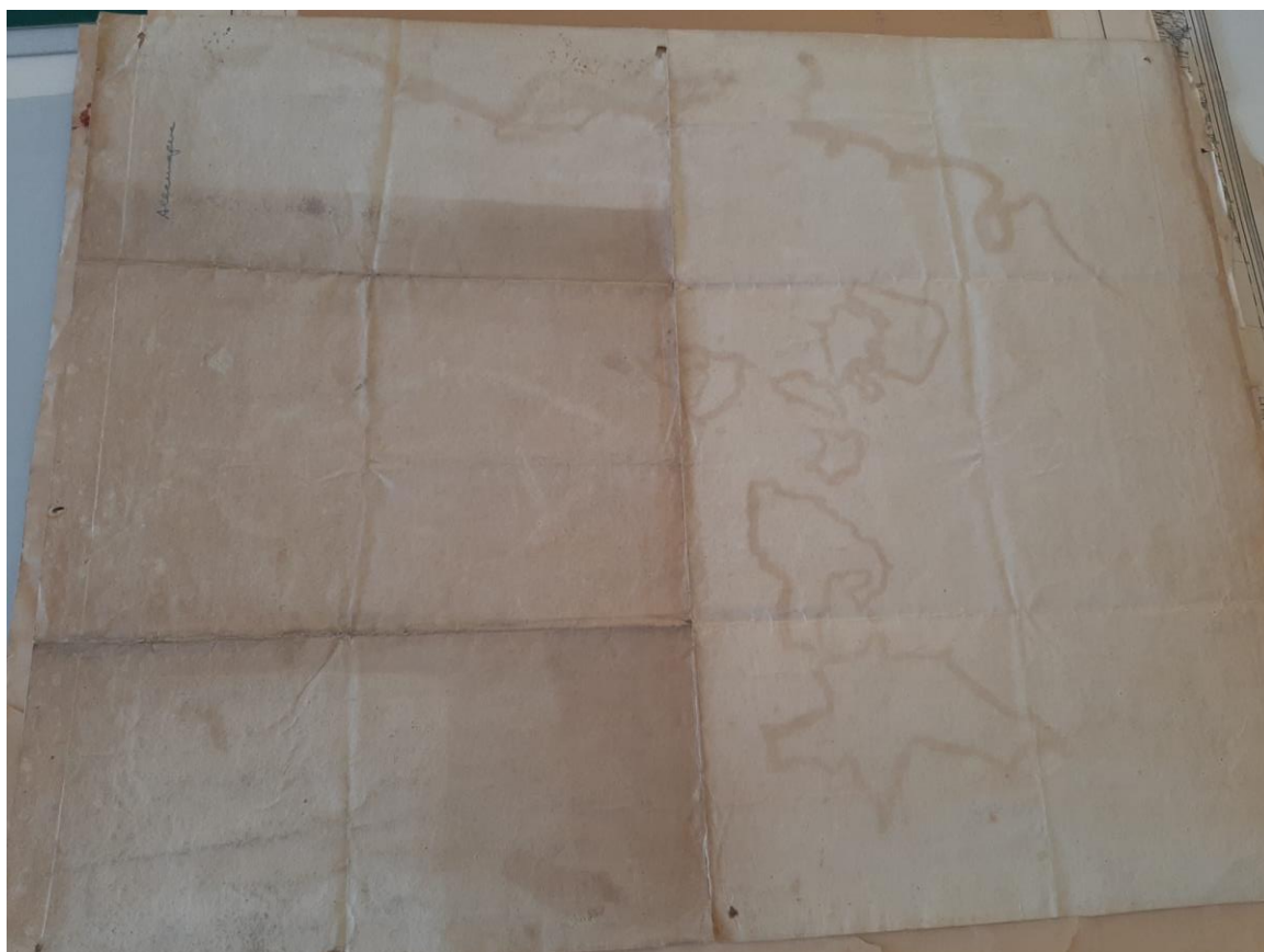
Figure 30 : Exemple de marques d'acidité
