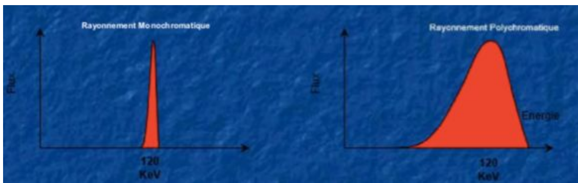
Figure 14. Représentation d'un rayonnement monochromatique couvrant une seule partie du spectre énergétique comparé à un rayonnement polychromatique couvrant lui une plus large portion des valeurs énergétiques. Image tirée du cours de Gaspoz, F., (2019)
