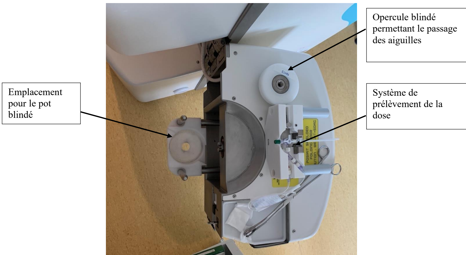
Figure 30 : Photo de la partie du Posijet où l'on place le pot blindé contenant le flacon de solution
