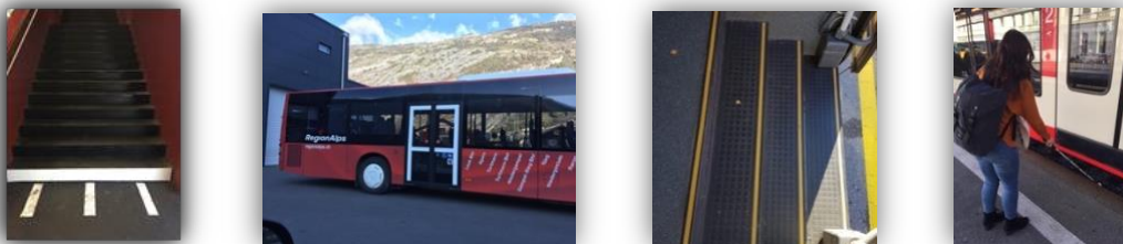
Abb.20: Je stärker die Farbkontraste sind, desto besser heben sie sich hervor. Manchmal werden die Kontraste am Boden dicker beschichtet, so dass sie mit dem weissen Stock wahrnehmbar sind (siehe Selbstexperimente, S. 55, 63, 23, 44).
