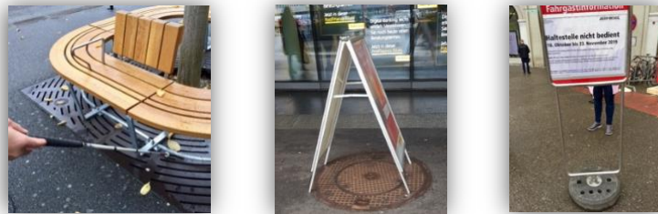
Abb.22: In Bern unter Sitzbänken befindet sich eine Stange, welche als Markierung dient. Das Hindernis kann mit dem weissen Stock vorzeitig wahrgenommen werden. Die Ständer und Plakate können mit einer Sockel markiert werden wie rechts abgebildet ist. Bei dem Plakat auf Foto zwei erkennt die Person je nach Annäherung nicht, dass sie auf ein Hindernis zusteuert (siehe Sozialraumforschung, S. 36, 39).
