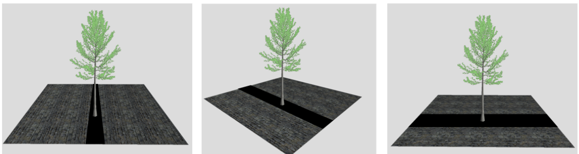
Figure 2.1 Exemple de billboard , l'arbre (ici une image appliqué sur un polygone) est en permanence orienté vers la caméra, quelque soit l'angle avec lequel la scène est observée.
