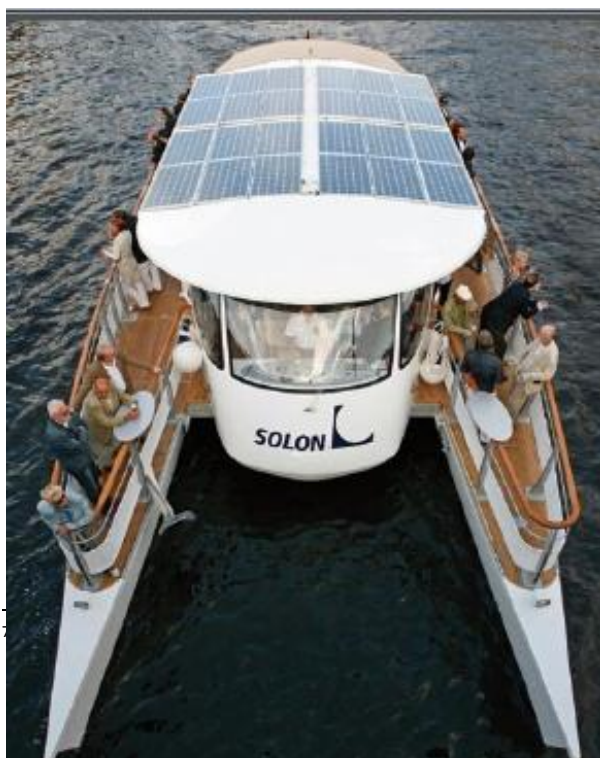
Figure 24. Le SunCat 58, 17,60 m de longueur et 6,85 mètres de largeur
