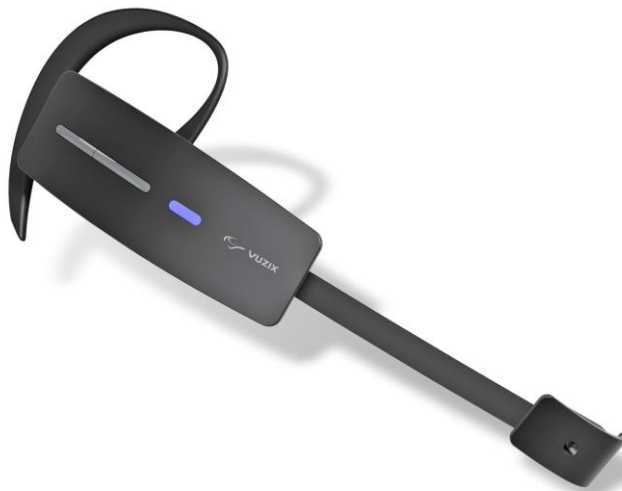
Figure 6 : Vuzix Glasses M100 avec la branche pour l'oreille et l'écran se trouve au bout de la branche principale
