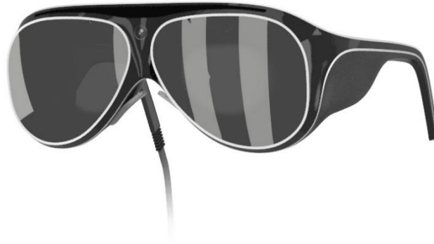
Figure 9 : MetaPro, la caméra se trouve au centre des lunettes avec un cordon sur un des branches
