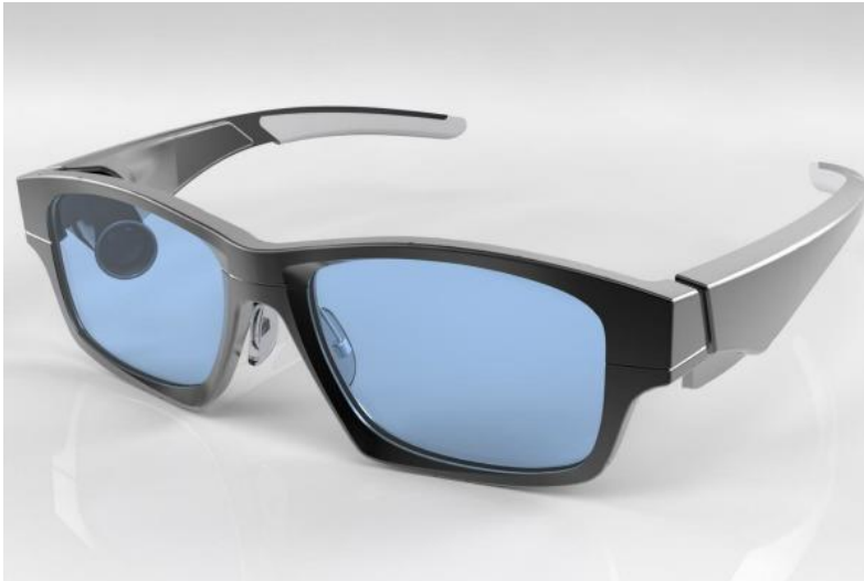
Figure 8 : GlassUp avec le projecteur qui se trouve à l'intérieur des lunettes
