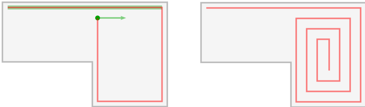
Figure 49 Évolution de tracé dans un polygone concave en l'absence de collision avec un sommet concave
