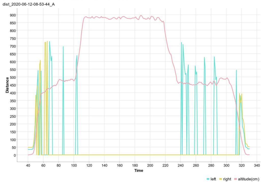
Figure 14: altitude est distance lidar [cm] en fonction du temps (intervalle de 0.5 sec.) lors d'un vol d'essai, image de l'auteur
