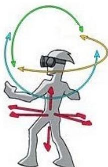
Figure 4 : Illustration du fonctionnement des 6 degrés de liberté
