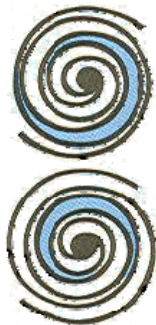
Fig.3.2.2.1 Compresseur scroll
