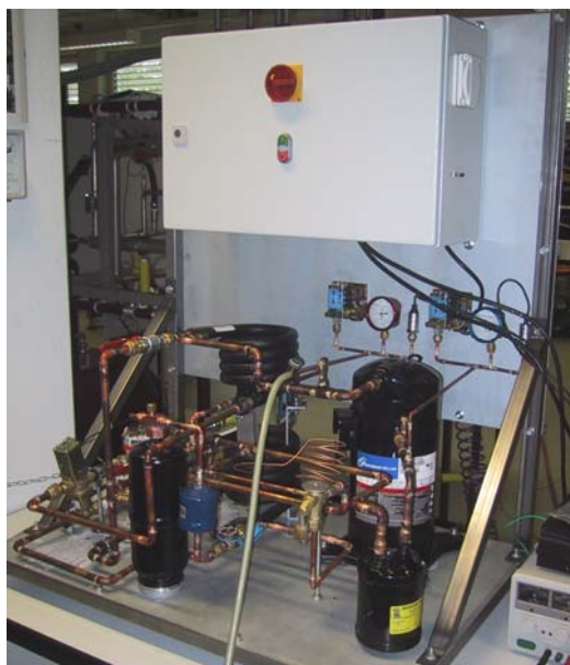
Fig.3.2.1 Installation et schéma technologique de la pompe à chaleur
