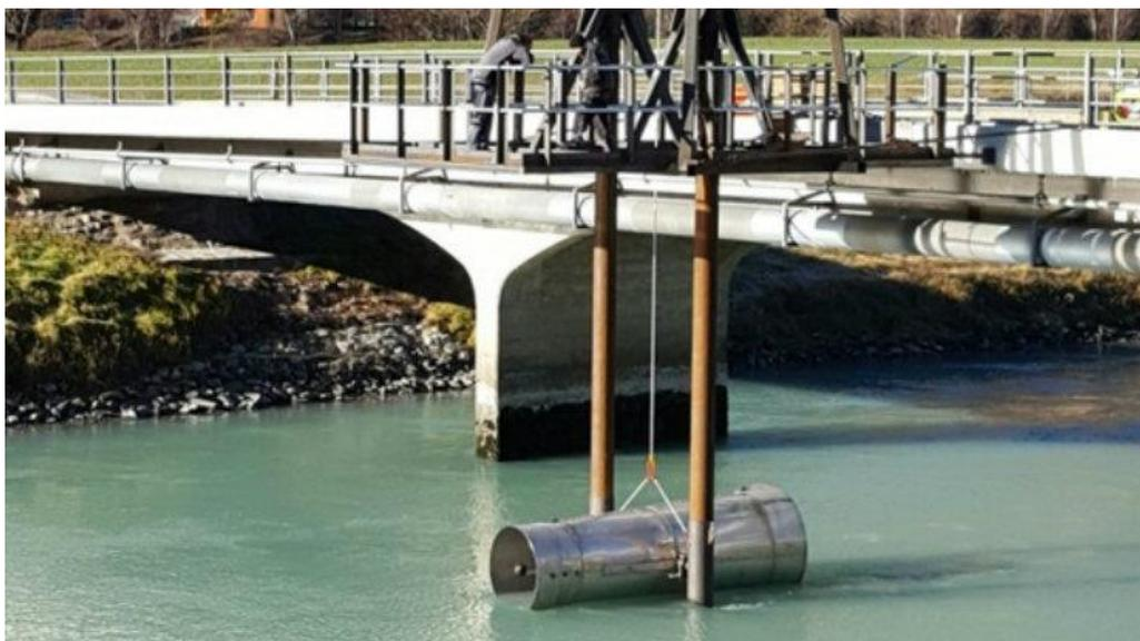
figure 5 : Prototype d'hydrolienne sur le canal de fuite de Lavey
