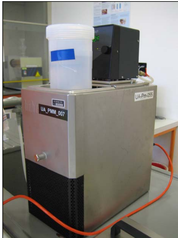
Abb. 13 : Versuchsanordnung zur Bestimmung des Diffusionskoeffizienten
