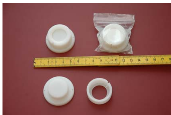
Abb. 1 : Vorgefertigte DGT-Einheiten [1]
