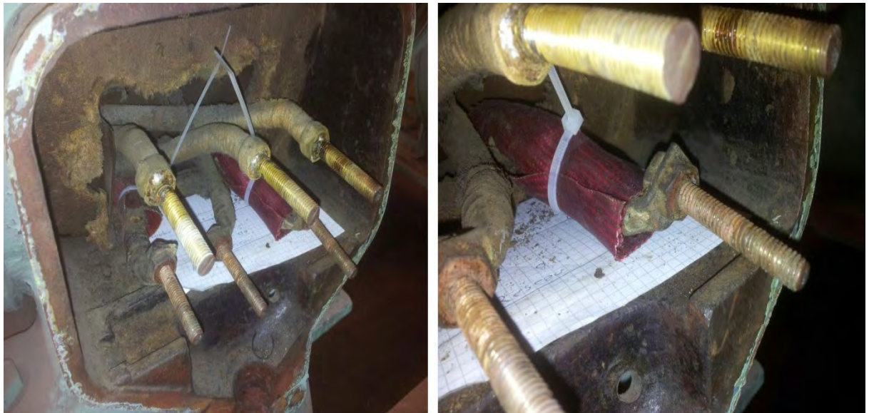
Figure 23 : Réparation des câbles blessés
