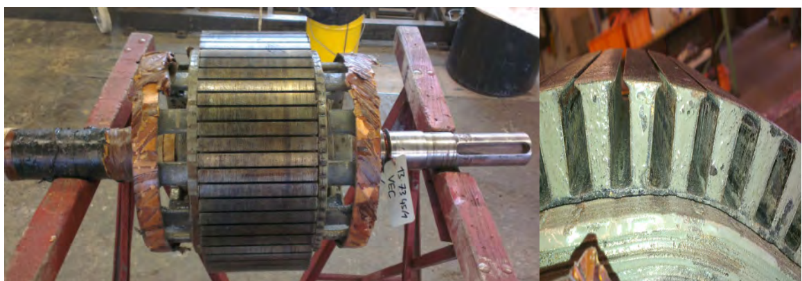
Figure 49 : Photo du fer du rotor après démontage
