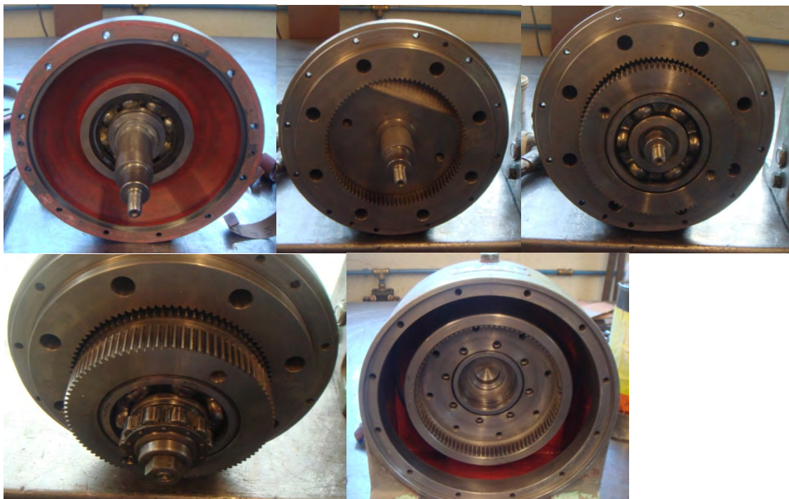
Figure 82 : Révision du réducteur de réglage de l'angle
