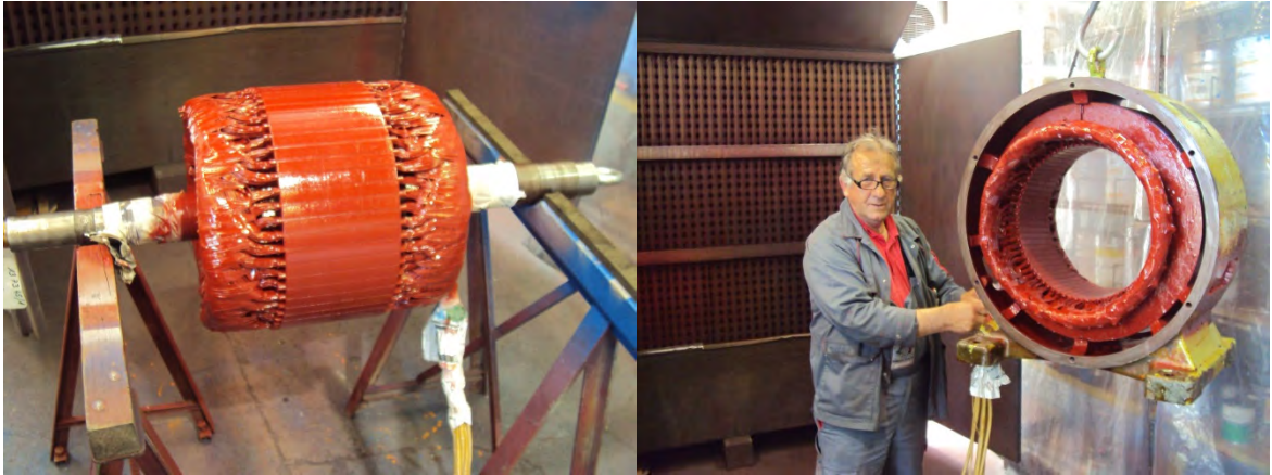
Figure 79 : Bobinage à neuf : rotor après imprégnation et grattage
