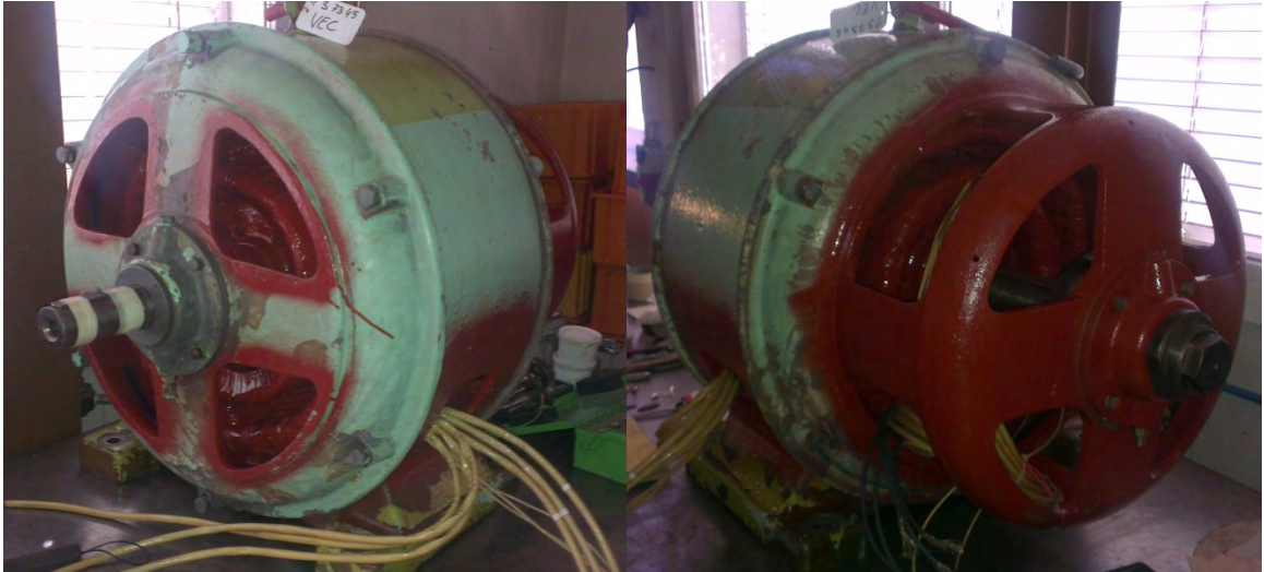
Figure 85 : Remise à neuf : montage de la machine à induction
