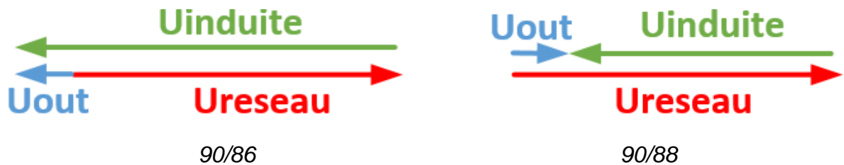
Figure 58 : Illustration des tensions de sortie et des tensions induites
