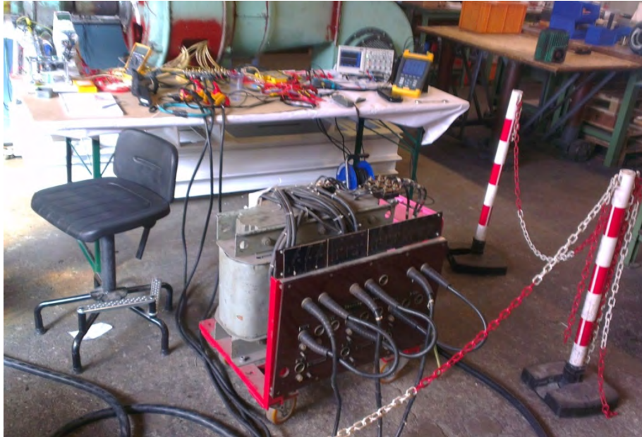
Figure 91 : Essai en court-circuit avec transformateur
