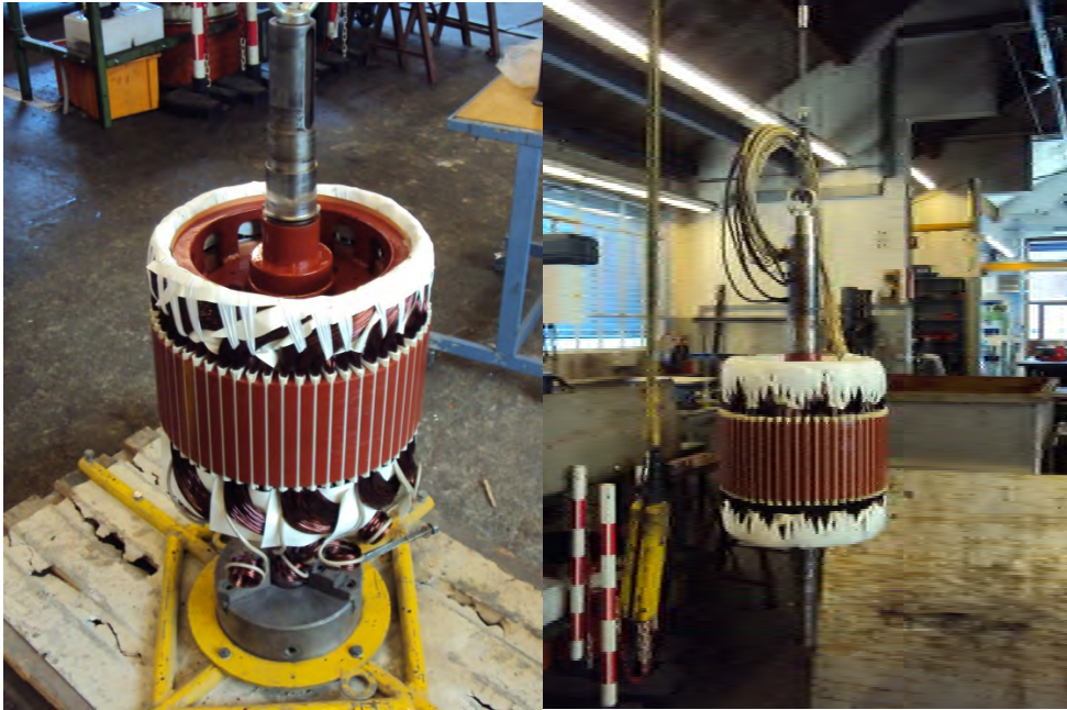
Figure 77: Bobinage à neuf : bobinage du rotor
