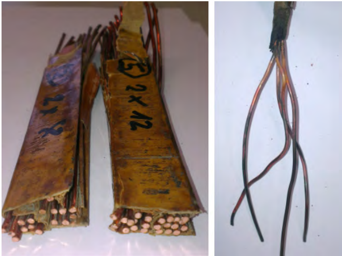
Figure 38 : Photo d'une encoche de 8 et de 12 spires et des 4 conducteurs en parallèle
