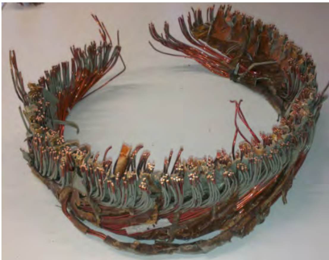
Figure 39 : Tête de bobine après démontage
