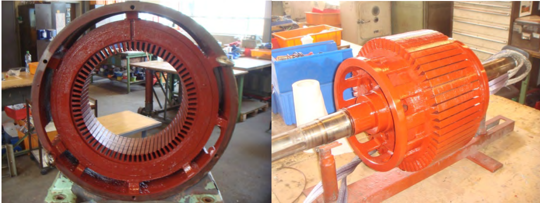
Figure 70 : Bobinage à neuf : vernis de protection isolant
