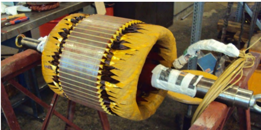
Figure 78 : Bobinage à neuf : rotor après imprégnation et grattage
