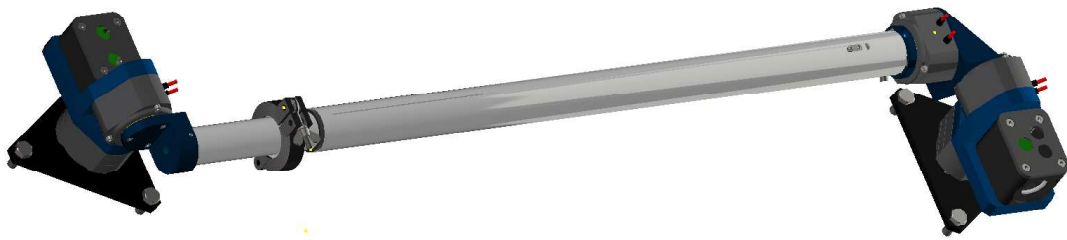
FIGURE 1: Extensomètre développé par la HES
