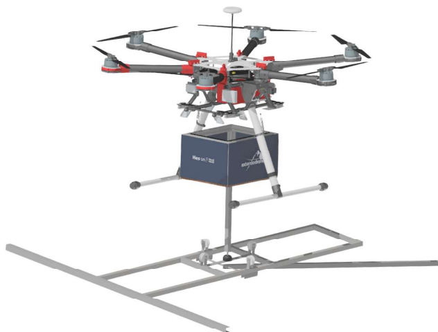
FIGURE 3: Vue 3D du drone, avec boîtier (en bleu) et structure suspendue devant tenir les points d’ancrage (voir figure 2)
