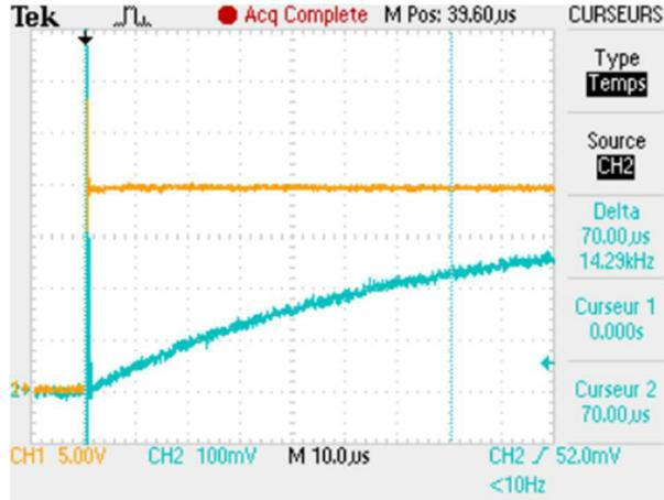
Figure 112 : Transformateur, mesure saut de tension
