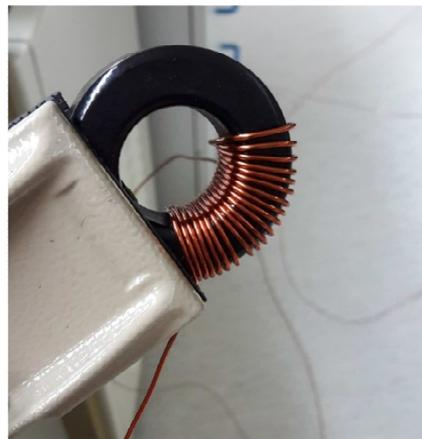
Figure 105 : Bobinage de l'inductance
