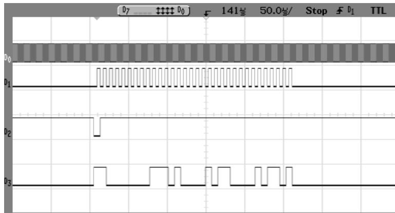
Abbildung 6-2: Takt- und Datensignale eines A/D-Wandlers
