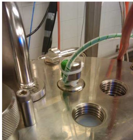
Abbildung 7-2: Die Stabsonde im Reaktor
